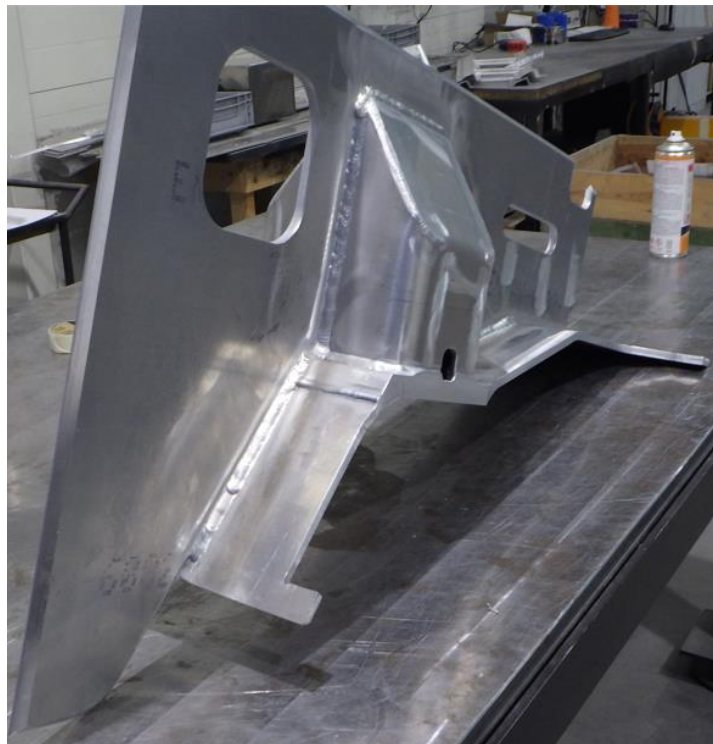
Slika 8.2 Prethodno očišćen i pripremljen uzorak za PT kontrolu zavara
