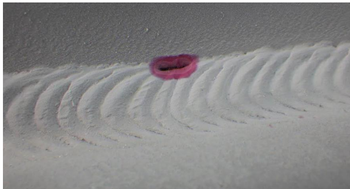
Slika 8.10 Neprotaljen rub faze zavara BW 4HY/4HY
