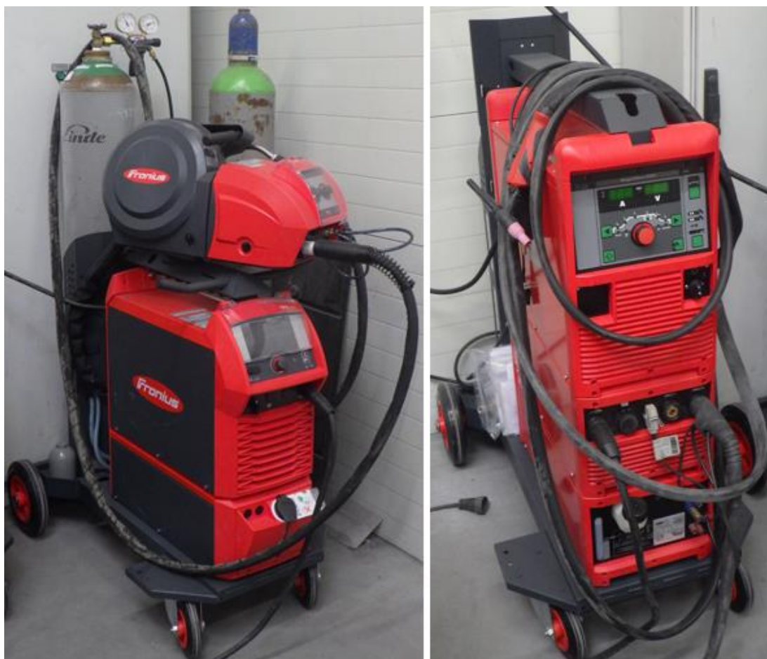
Slika 7.3 Uredaji za MIG i TIG postupke zavarivanja
