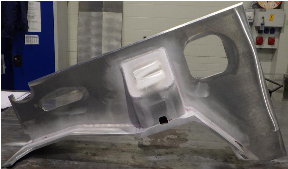
Slika 8.4 Nanesen razvijač na ispitnu površinu konzole
