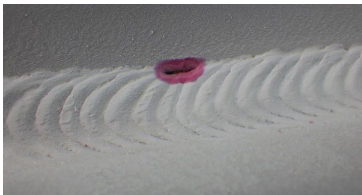
Slika 8.10 Neprotaljen rub faze zavara BW 4HY/4HY
