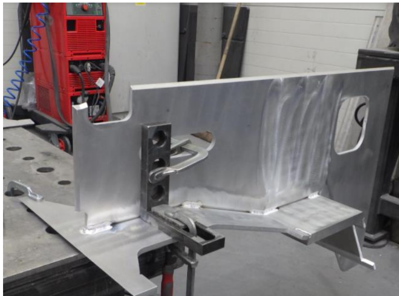
Slika 7.7 Spajanje donjeg segmenta i stražnje ploče
