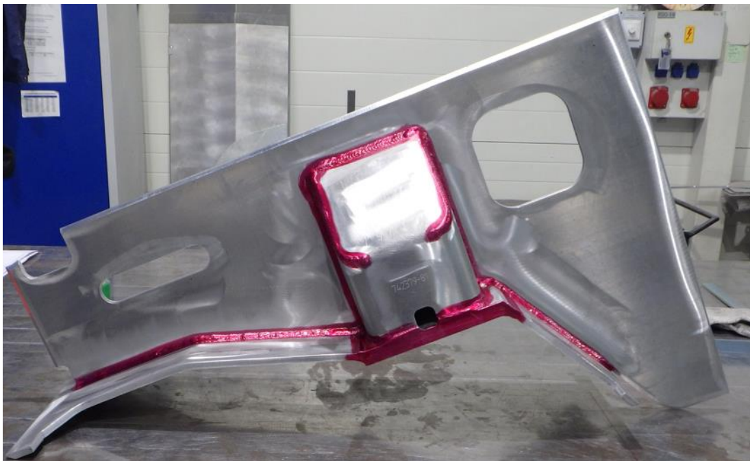
Slika 8.3 Nanesen penetrant na ispitnu površinu konzole
