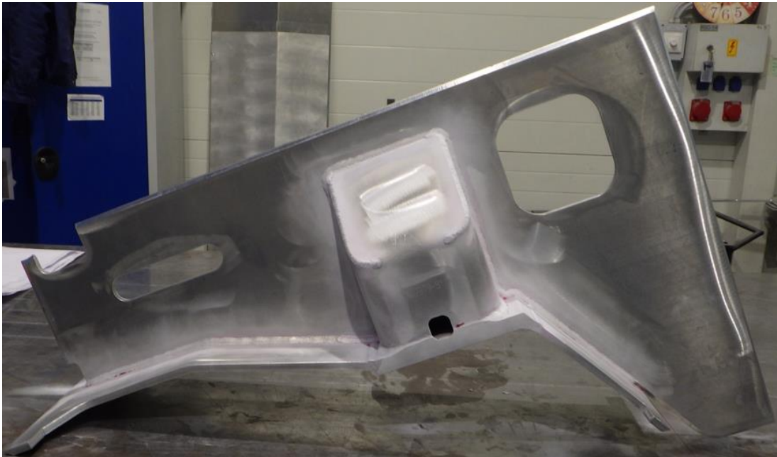
Slika 8.4 Nanesen razvijaa na ispitnu površinu konzole
