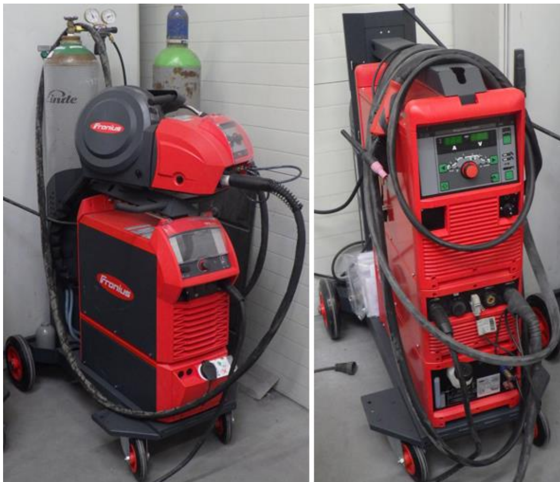
Slika 7.3 Uredaji za MIG i TIG postupke zavarivanja
