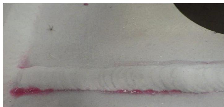
Slika 8.14 Naljepljivanje na korijenskom dijelu zavara BW 10HV/KP
