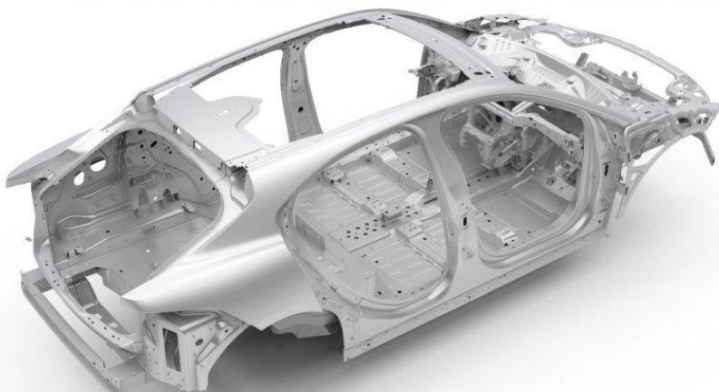
**Slika 2.1 Aluminij kao konstrukcijski materijal u autoindustriji [2]**
