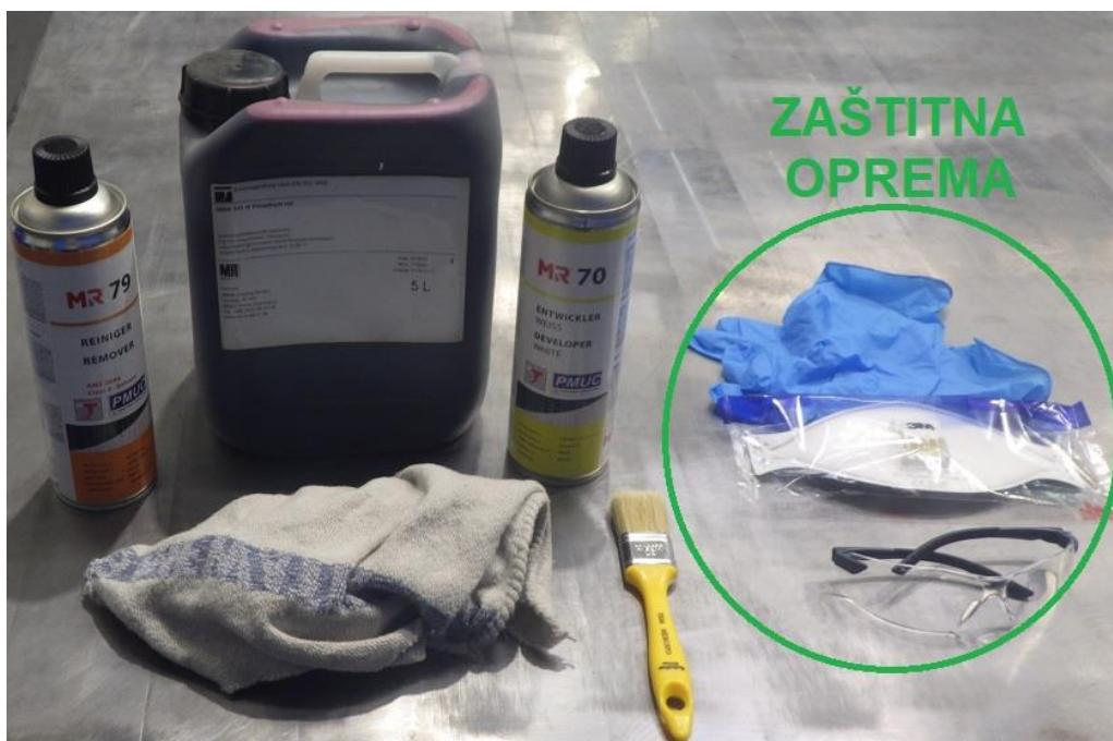
Slika 8.1 Oprema za PT ispitivanje zavara
