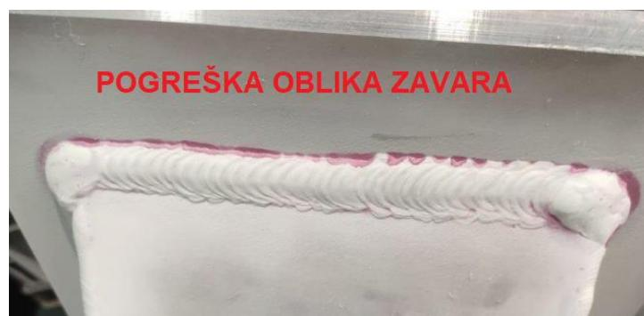
Slika 8.8 Lokalne isprekidane ugorine na zavaru 5HY
