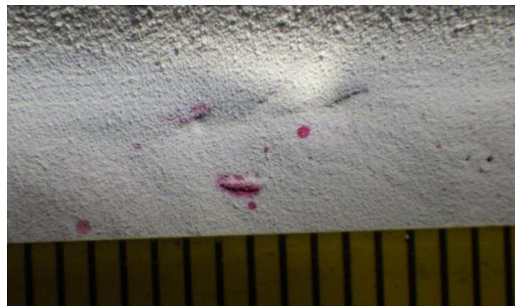
Slika 8.15 Uzdužna pukotina na zavaru BW 4HY/4HY
