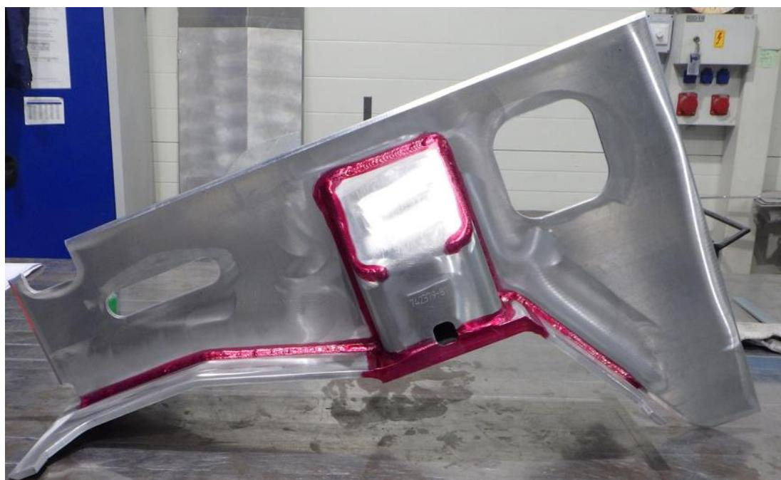
Slika 8.3 Nanesen penetrant na ispitnu površinu konzole
