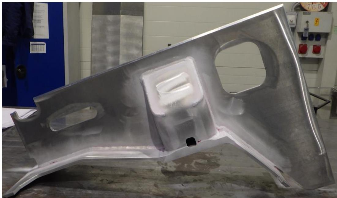
**Slika 8.4 Nanesen razvijač na ispitnu površinu konzole**
