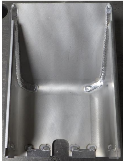
Slika 7.9 Zavarena podrška s pripojenim podloškama
