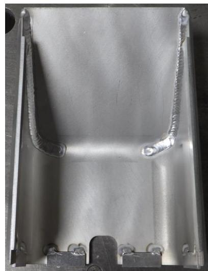
**Slika 7.9 Zavarena podrška s pripojenim podloškama**
