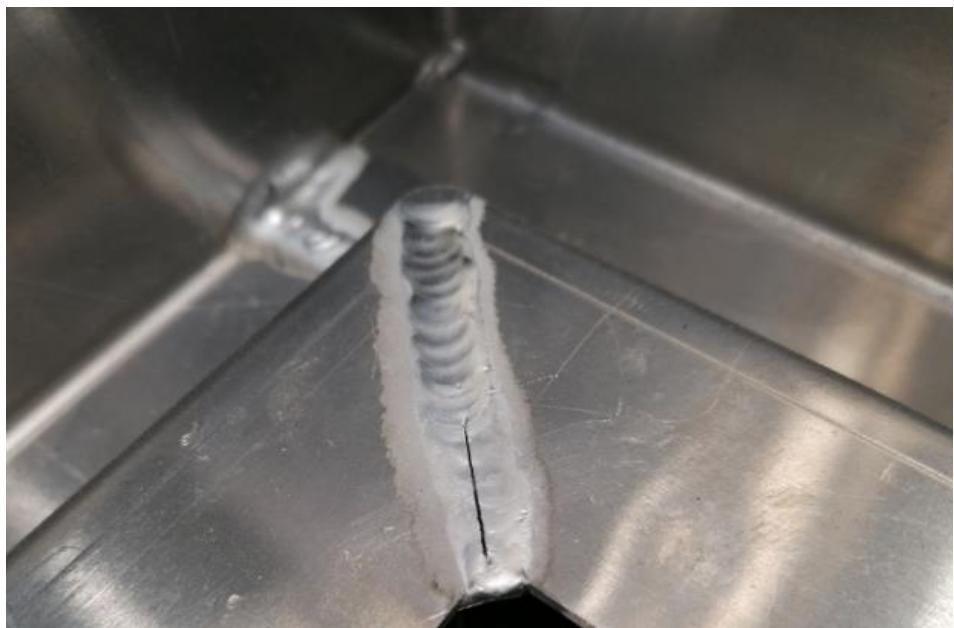
Slika 4.2 Primjer uzdužne pukotine u smjeru zavara
