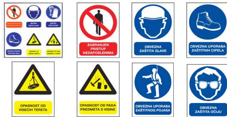
Slika 3.2 Ploče oznaka Zaštite na radu na gradilištu [1]
