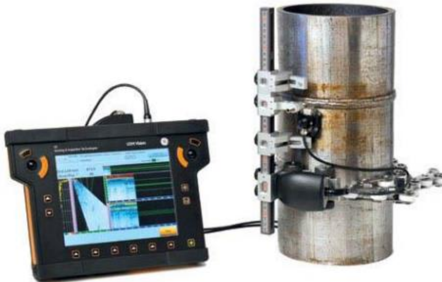
Slika 18. Uređaj za ultrazvučno ispitivanje
