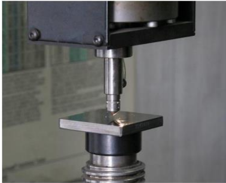
Slika 7. Uređaj za ispitivanje tvrdoće po Vickersu
