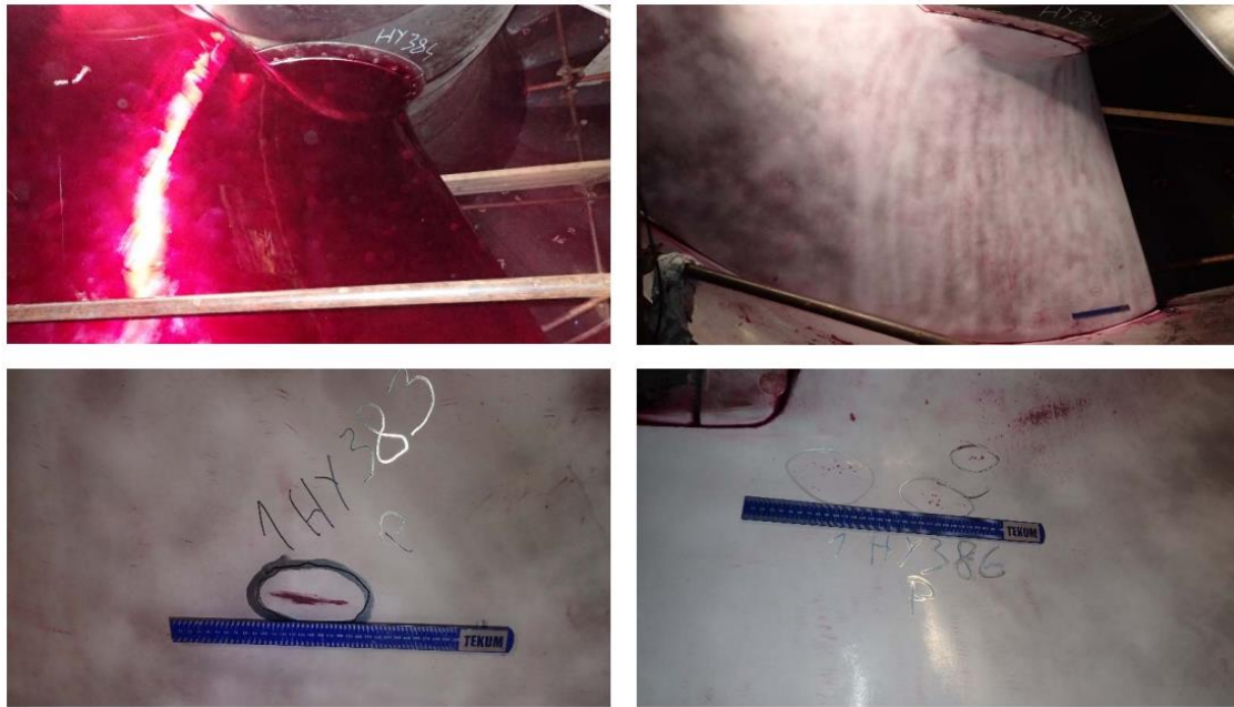
Slika 26. Oštećenja utvrđena penetrantskom metodom
