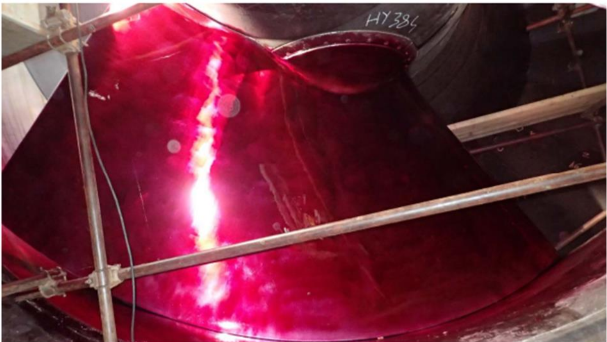
Slika 24. Tretirana lopatica radnog kola
