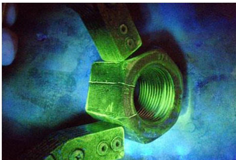
Slika 20. Rezultat magnetske metode ispitivanja
