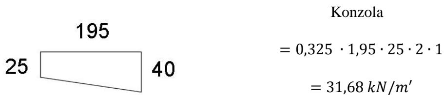
Stalno opterećenje po dužnom metru nosača:
