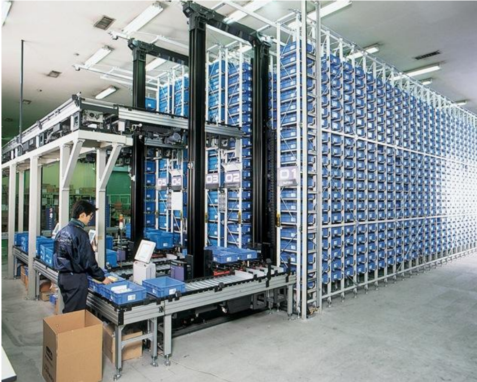
Slika 4.6 Mini load AS/RS [12]
