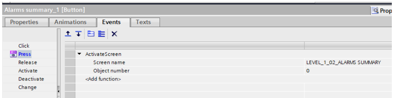
Slika 10 Primjer gumba za alarme na templateu
