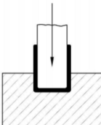
*Slika 9. Savijanje lima u U profil [15]*
