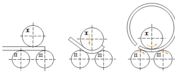
Slika 11. Postupak kružnog savijanja lima [17]
