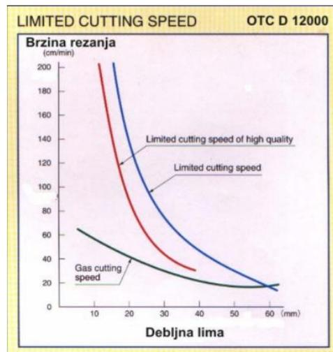
*Dijagram 1. Ovisnost brzine rezanja o debljini materijala*
