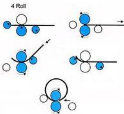
Slika 12. Različiti načini savijanja lima sa četiri valjka [18]
