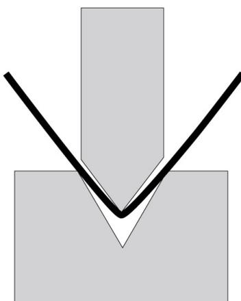
*Slika 8. Savijanje lima u V profil [14]*
