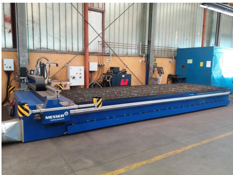
Slika 22. CNC plazma rezač MESSER
