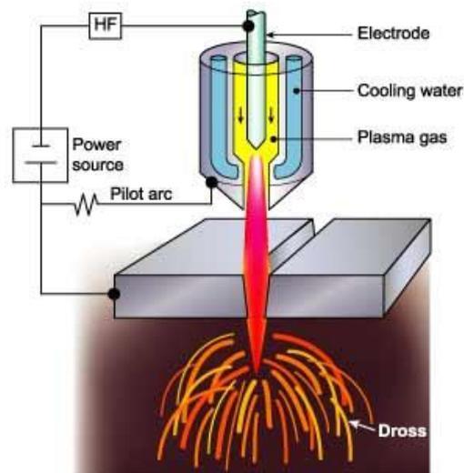
Slika 23. Postupak plazma rezanja [40]
