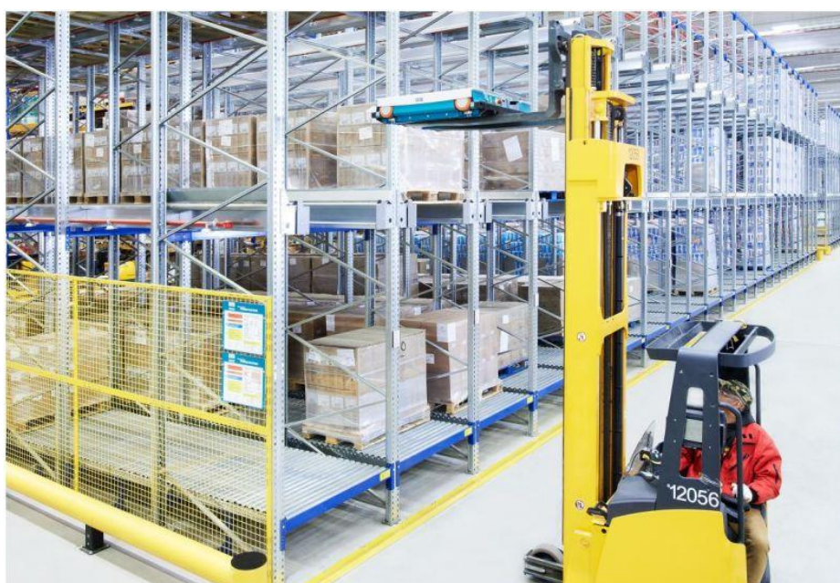
Slika 3.4.1. – BITO PROMotion Shuttle regalni sustav [23]
