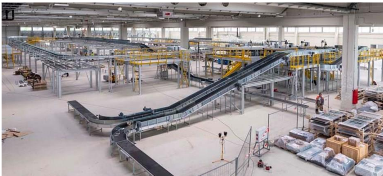
Slika 2.5.5. Pokretna traka u sabirnom centru Hrvatske Pošte [18]
