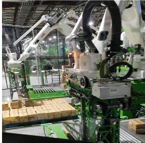
Slika 28: Prikaz robota koji slaže izlaznu robu na paletu.
