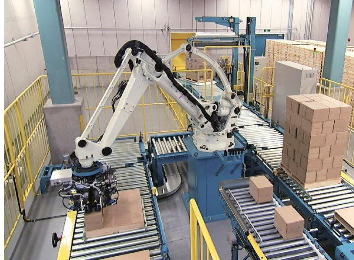
Slika 17: Robotski sistem paletizacije [36]
