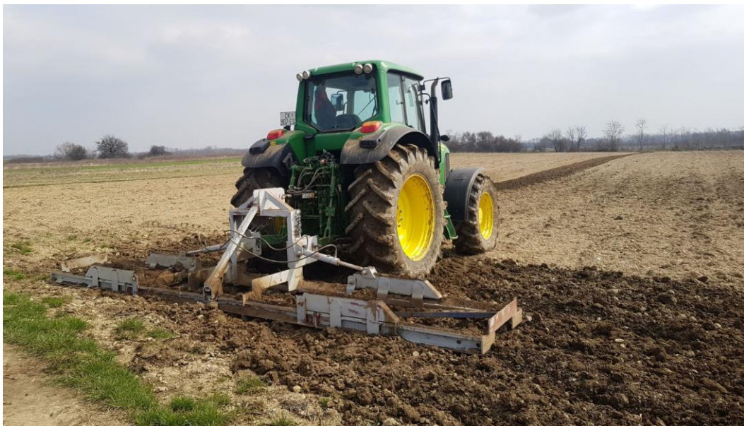
Slika 2. Obrada tla teškim šinjama
