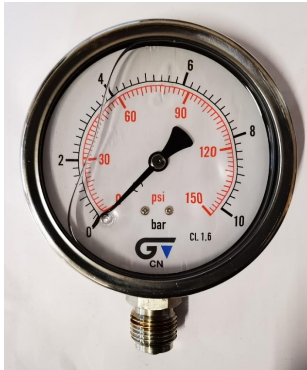
Slika 9. Kontrolna oprema – manometar
