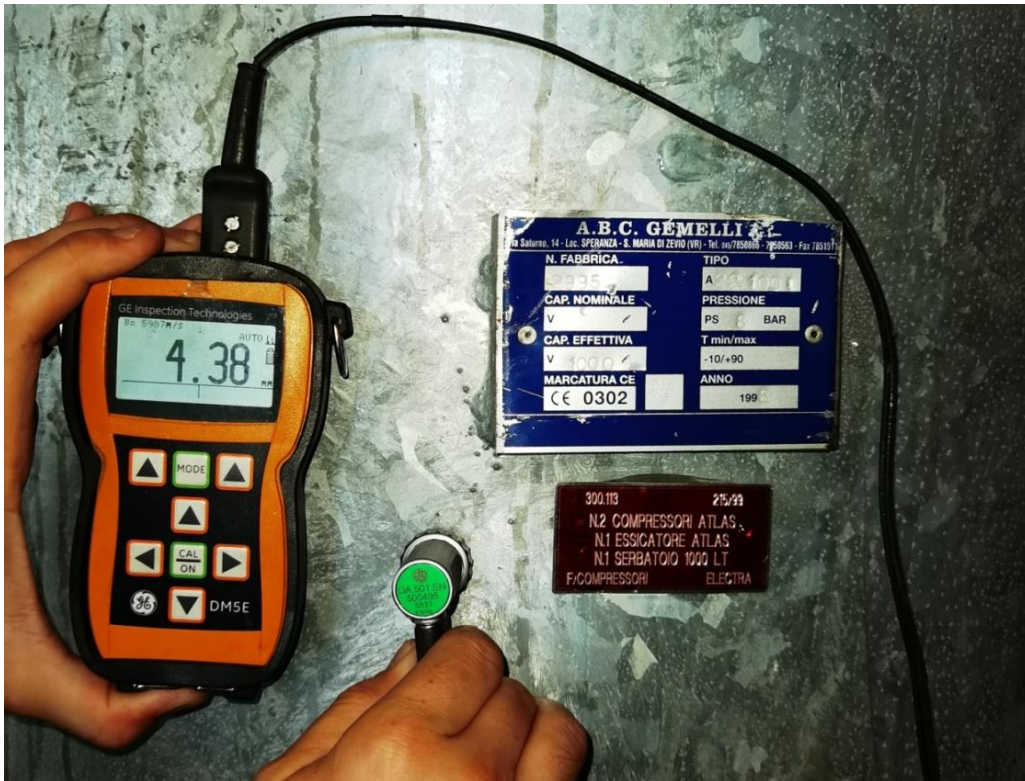
Slika 11. Ultrazvučno mjerenje debljine stjenke
