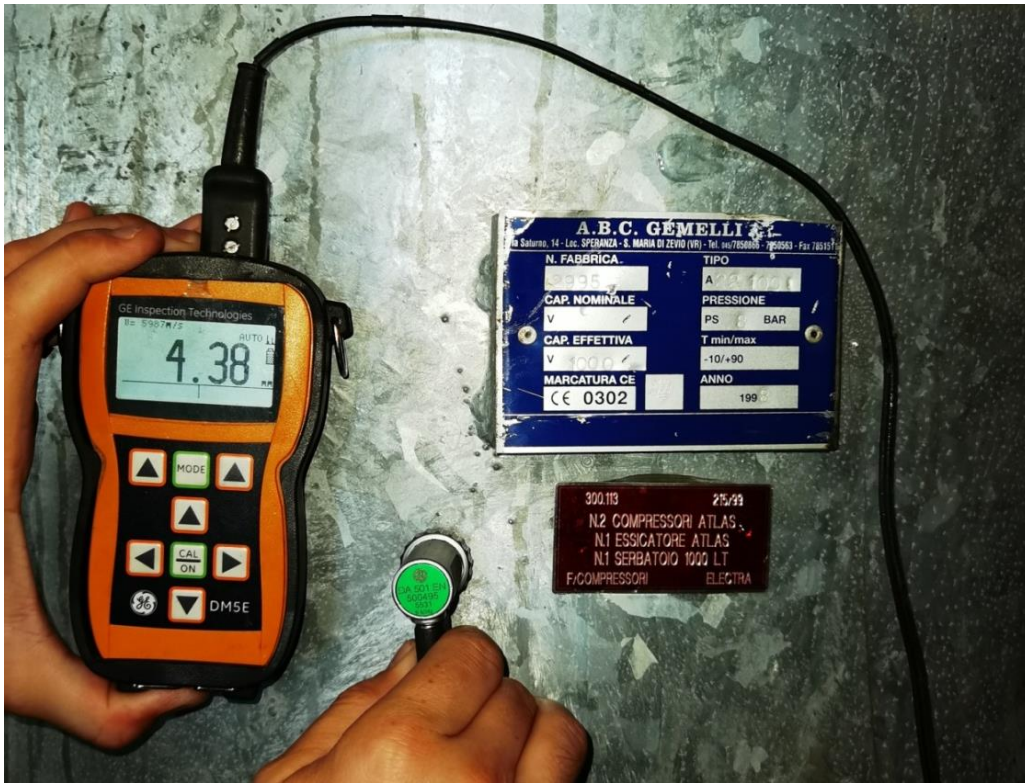
Slika 11. Ultrazvučno mjerenje debljine stjenke
