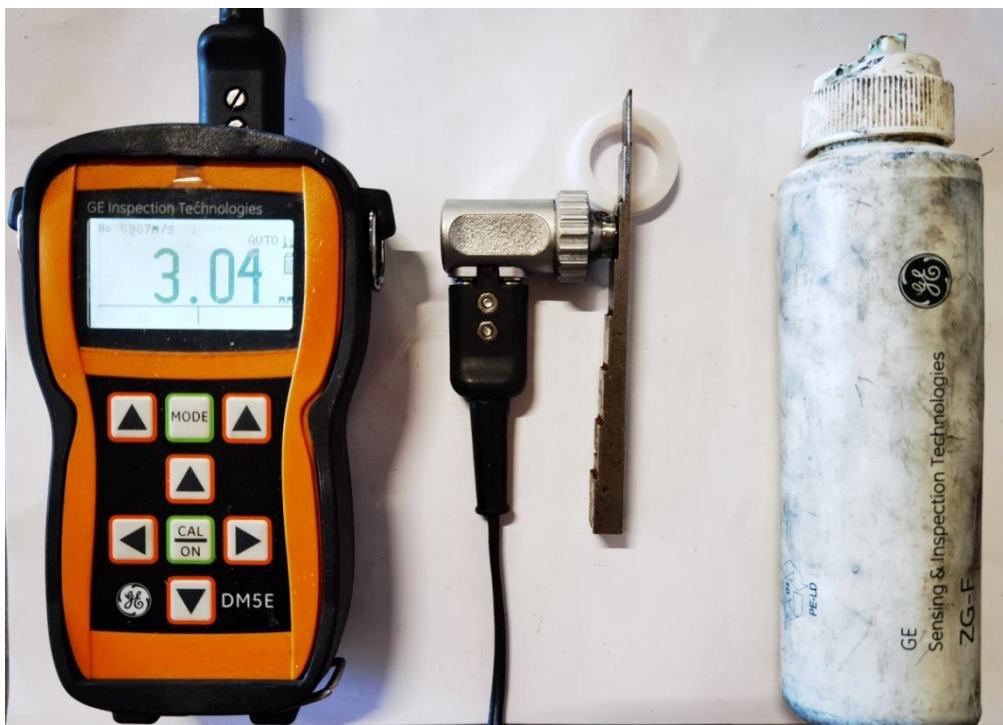
Slika 12. Instrument i oprema za ultrazvučno mjerenje debljine stjenke
