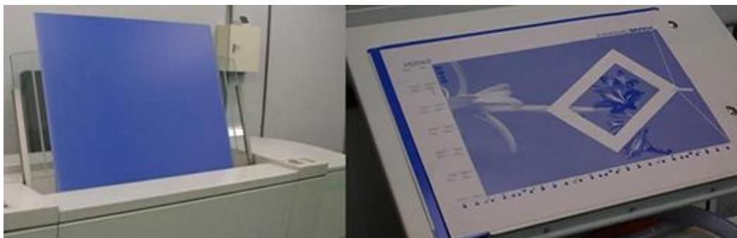
Slika 4.5 Primjer ofsetne tiskovne forme prije (lijevo) i poslije izrade (desno)
