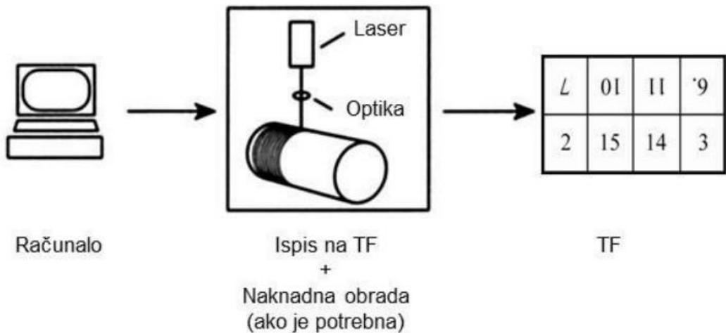
*Slika 2.3 Osnovni elementi Computer to Plate sustava*
