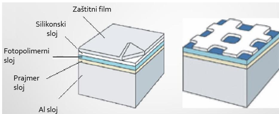
*Slika 2.14 Tiskovna forma za bezvodni offset s aluminijskom osnovom prije (lijevo) i poslije (desno) osvjetljavanja*
