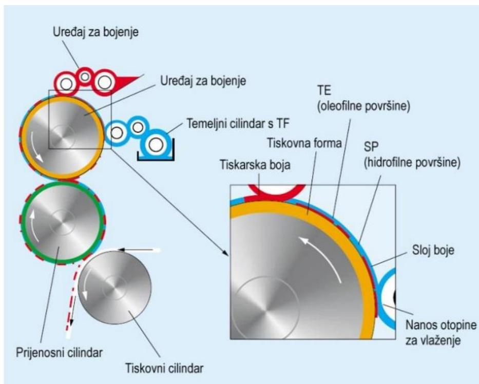
Slika 2.18 Princip rada offsetnog tiska
