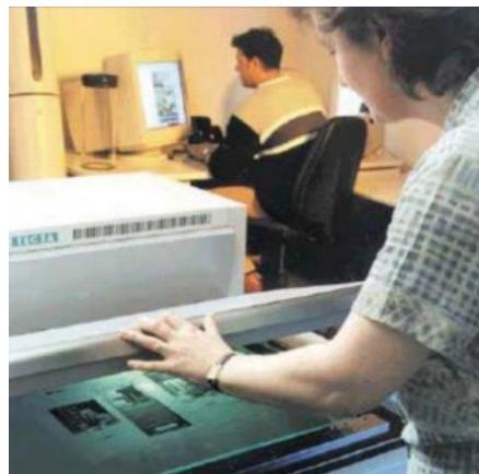
Slika 4.1 Primjer skenera s copy-dot funkcijom
