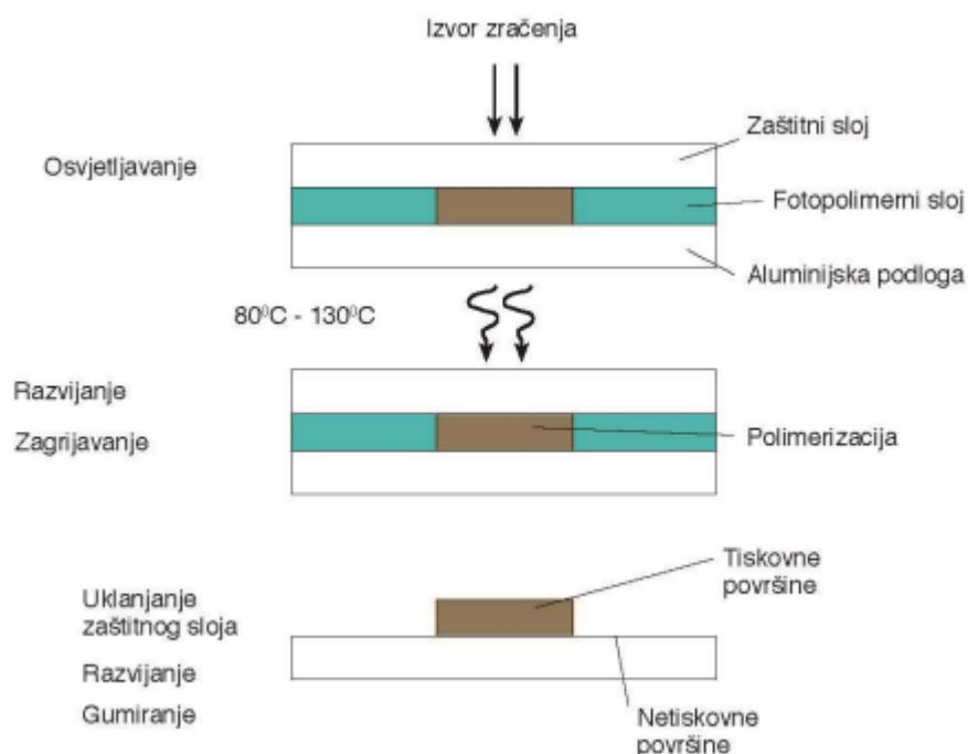
Slika 2.5 Proces nastajanja tiskovnih elemenata s fotopolimernim slojem
