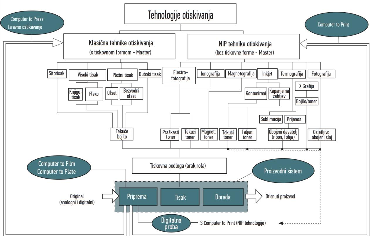
Slika 2.12. Moguće tehnike otiskivanja na principu tehnikije digitalnog tiska
