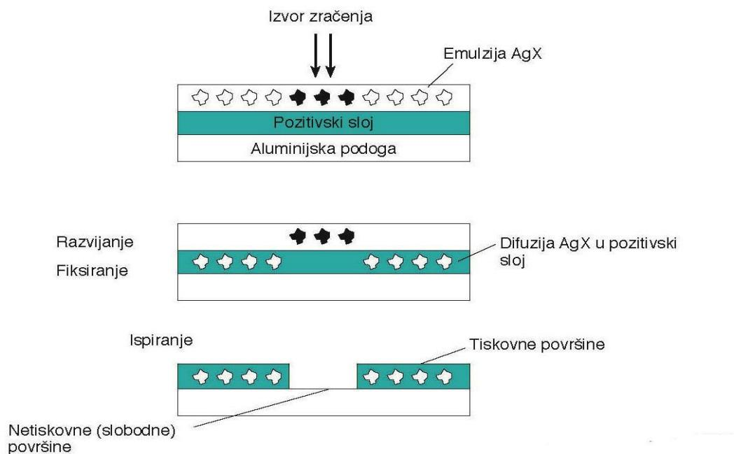
*Slika 2.4 Razvijanje i osvjetljavanje tiskovnih formi na bazi srebro halogenida*
