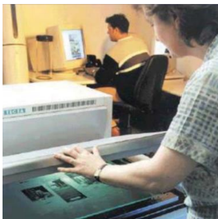
Slika 4.1 Primjer skenera s copy-dot funkcijom
