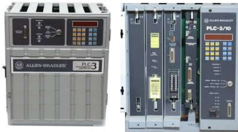
Slika 3. 1 Primjer prvog PLC-a Allen Bradley [5]
