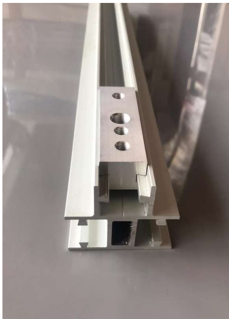
Slika 5. 1 Izgled korištenog eloksiranog aluminijskog profila
