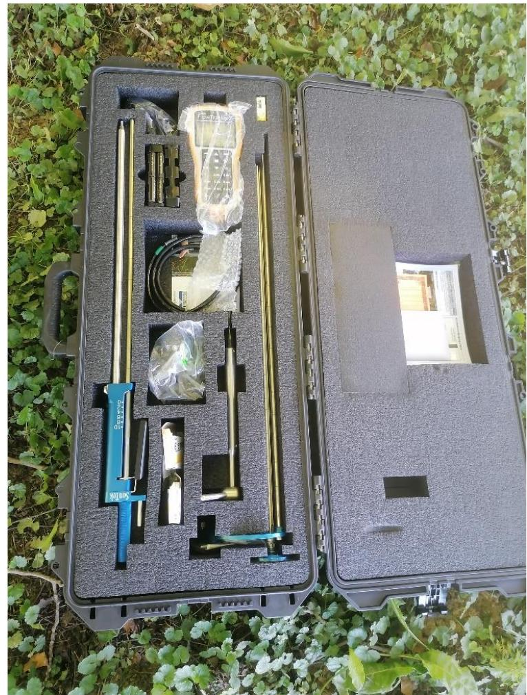
Slika 3.5. Ultrazvučni mjerač protoka Flow Tracker 2
