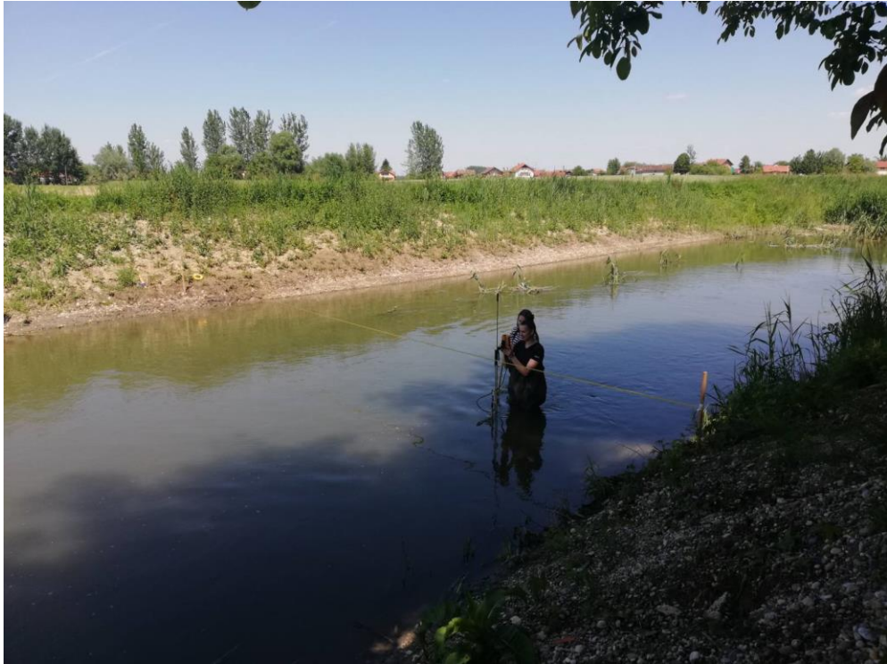
Slika 3.4. Prikaz prvog (02.06.2021.) hidrometrijskog mjerenja na rijeci Plitvici u mjestu Luka Ludbreška u uvjetima relativno neobraslog korita [3]
