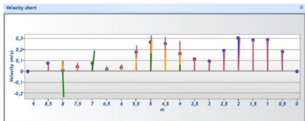
Slika 4.11. Dijagram brzine u koritu s trećeg mjerena 03.09.2021.
