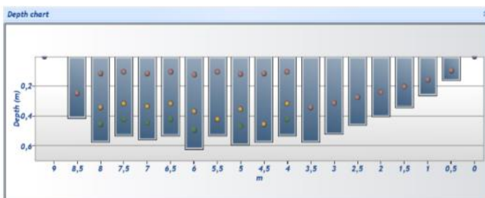
Slika 4.12. Dijagram dubine u koritu s trećeg mjerenja 03.09.2021.
