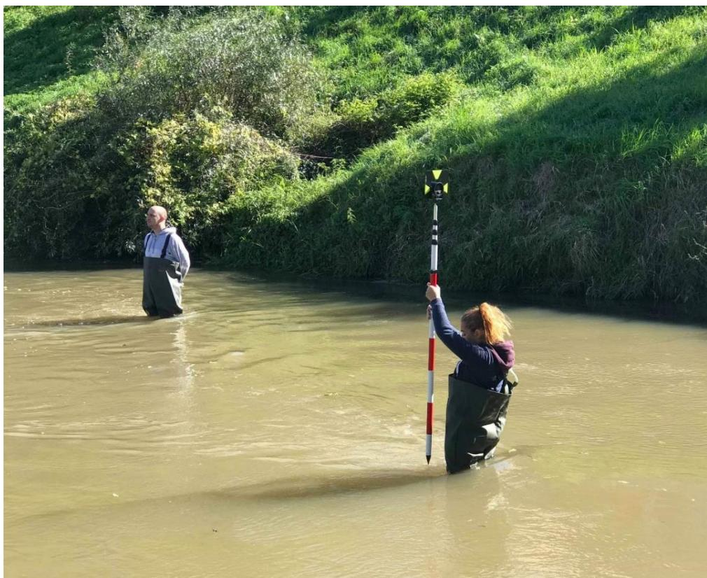
*Slika 2.2. Geodetsko određivanje nagiba dna vodotoka [3]*
