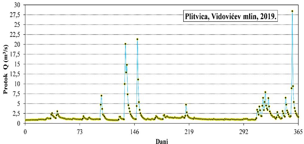
*Slika 3.3. Hidrogram (prikaz srednjih dnevnih protoka) rijeke Plitvice kod Varaždina na mjernoj postaji Vidovićev mlin za 2019. godinu [9]*
