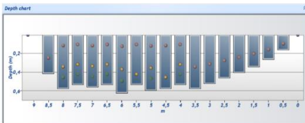
Slika 4.12. Dijagram dubine u koritu s trećeg mjerenja 03.09.2021.
