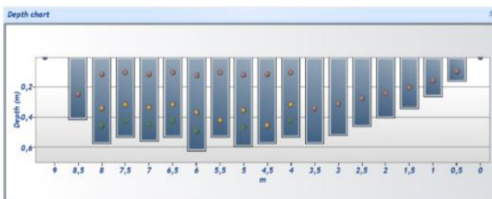
Slika 4.12. Dijagram dubine u koritu s trećeg mjerenja 03.09.2021.
