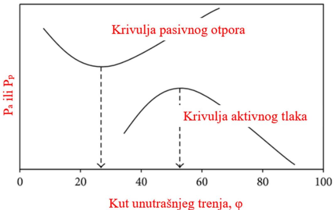
Slika 6 : Krivulje iznosa aktivnog tlaka i pasivnog otpora
