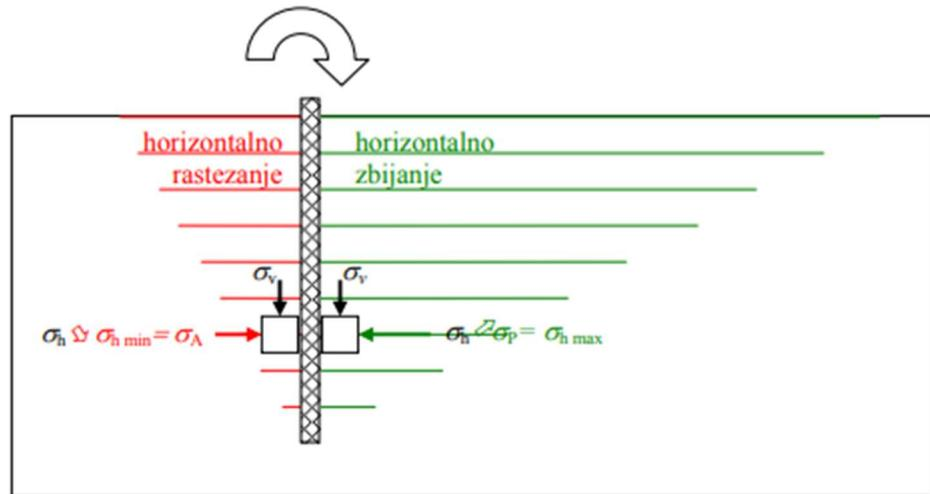
Slika 5 : Shematski prikaz nastanka aktivnog tlaka i pasivnog otpora [5]
