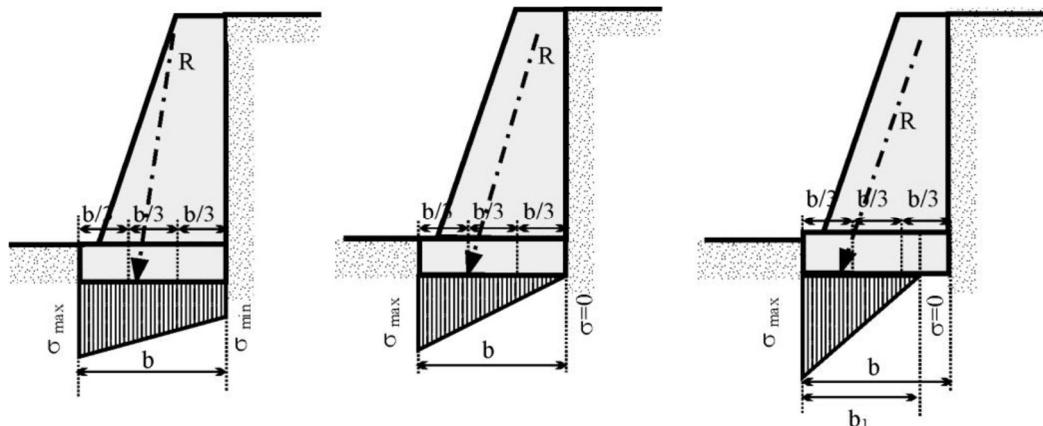
Slika 15 : Nejednolika raspodjela naprezanja ispod temeljne stope
