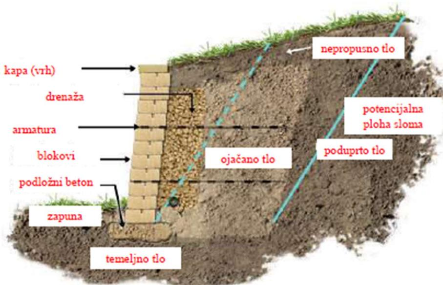
Slika 17 : Poprečni presjek ojačanog tla [6]
