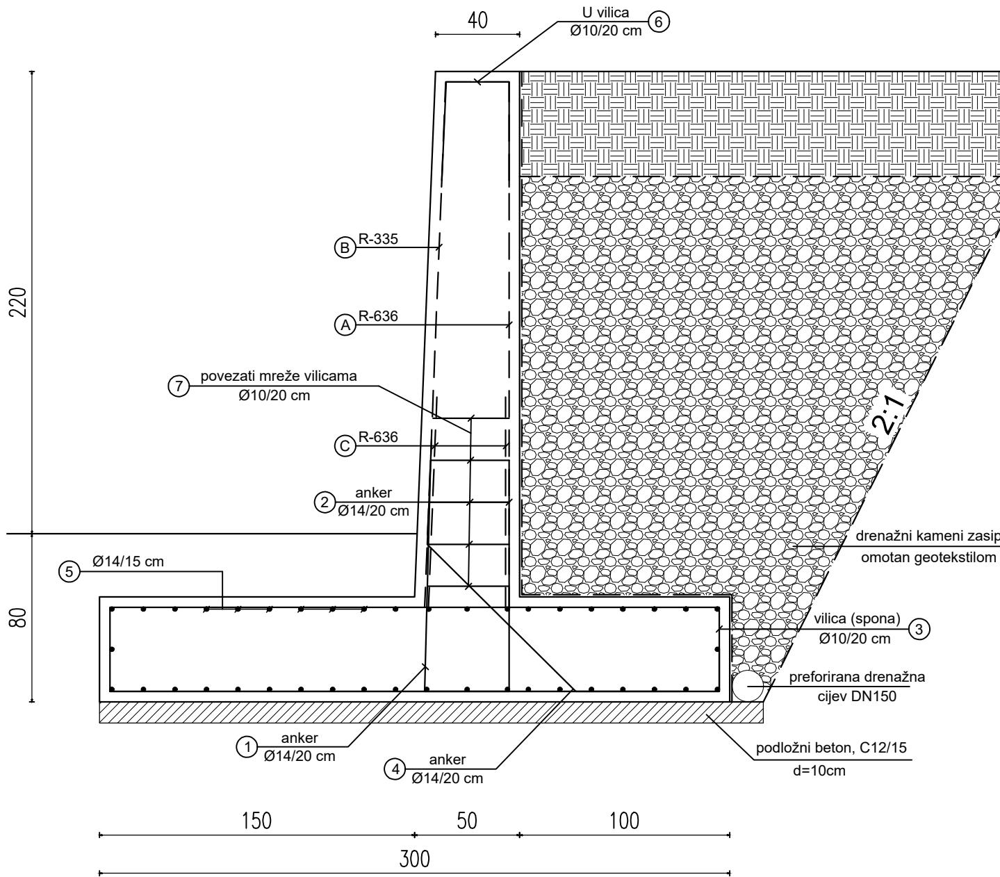
B500B - mrežna armatura - specifikacija za 1 dužni metar zida
