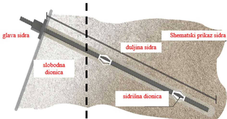
Slika 24 : Dijelovi geotehničkog sidra
