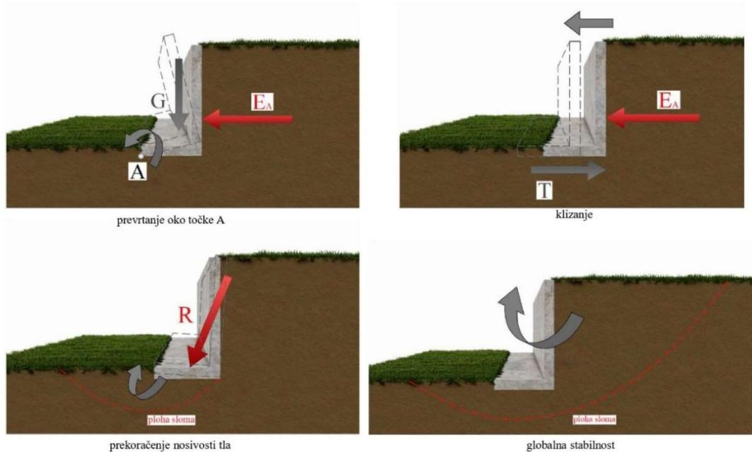
Slika 11 : Mehanizmi sloma potpornog zida
