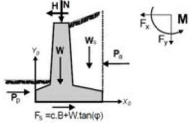
$$\text{Trenje tla } R_d = N_d \cdot \tan(\phi / \gamma M) = 68,494 \text{ kN/m'}$$
