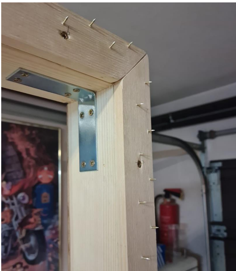
Slika 13. Vizualni prikaz letve i čavlića za držanje platna na okviru
