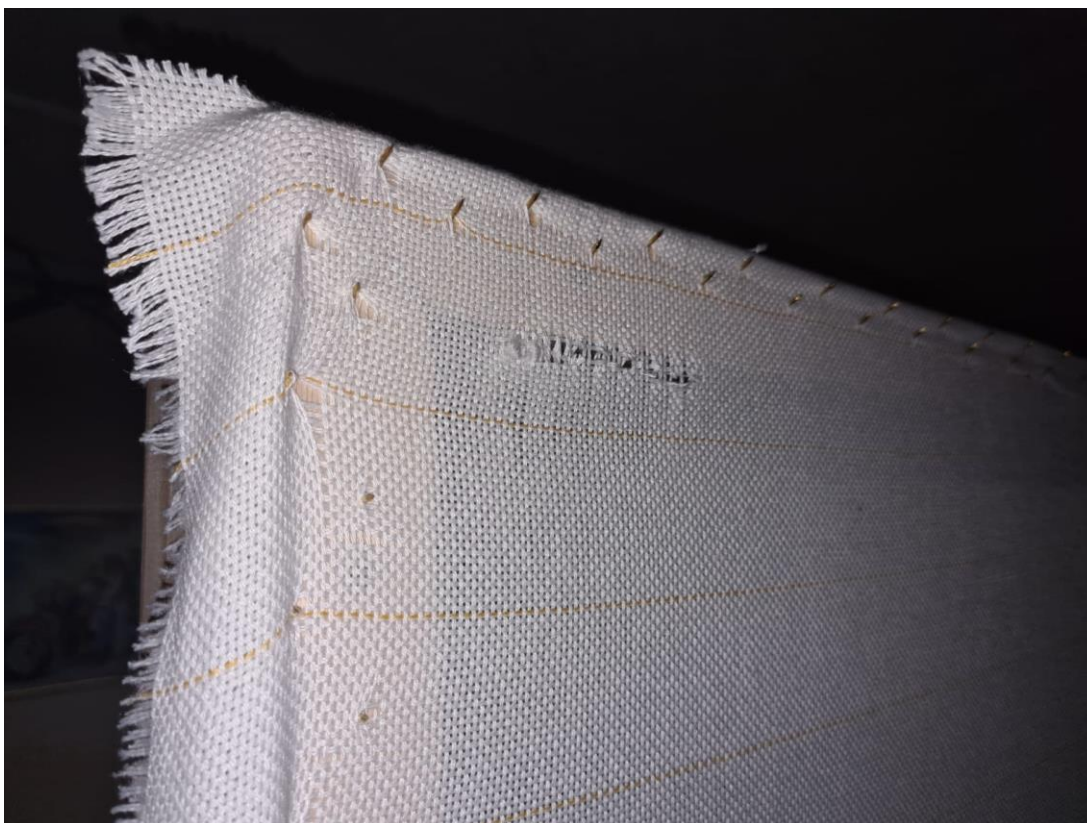
Slika 14. Vizualni prikaz letve koja drži platno na okviru
