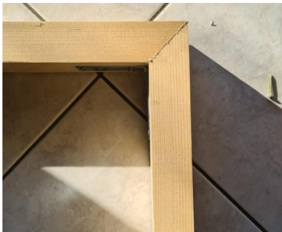
Slika 10. Vizualni prikaz spoja okvira
