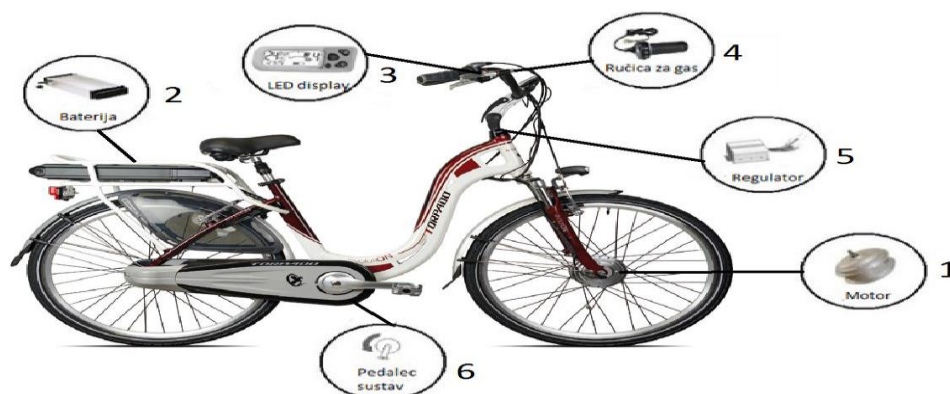
Slika 37. Osnovni dijelovi električne bicikle
