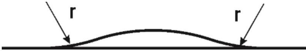
Slika 11. K35 - Umjetne izbočine
