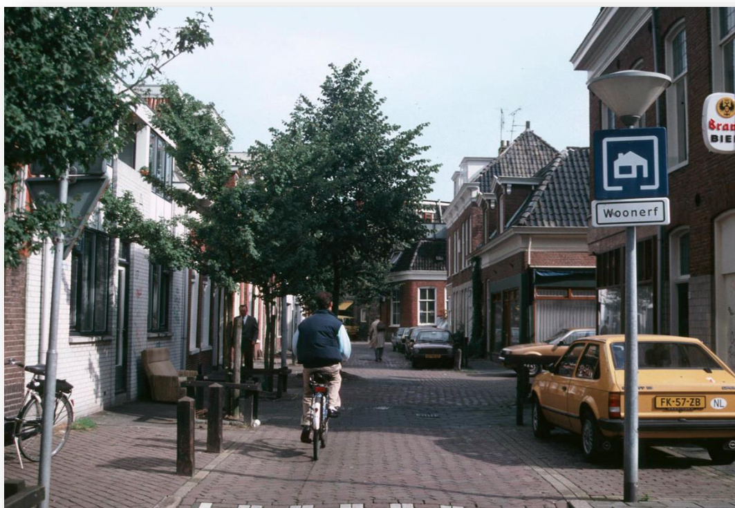
Slika 5. Prikaz „Woonerf“ modela smirivanja prometa
