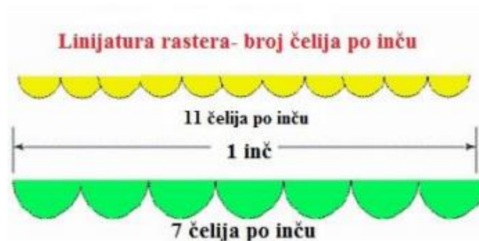
Slika 29. – Različita linijatura aniloks valjka
