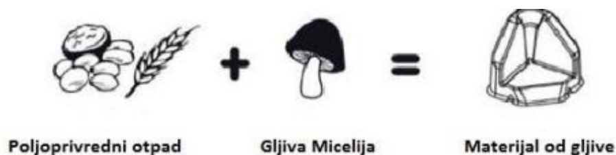
Slika 11. Postupak izrade ambalaže od gljive [31]
