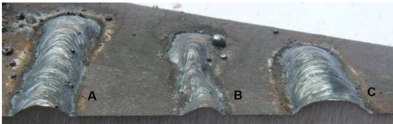
Slika 4.6 Uključci troske na površini zavarenog spoja
