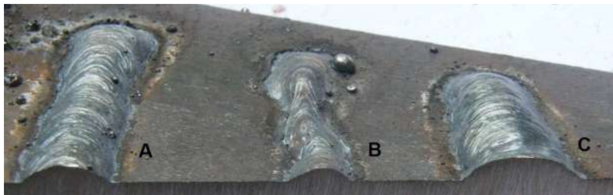
Slika 4.6 Uključci troske na površini zavarenog spoja
