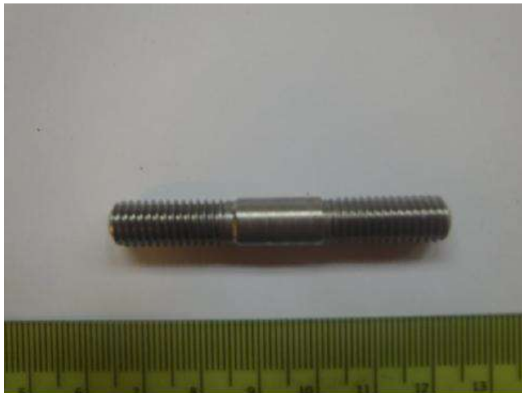
Slika 6.2 Implatni uzorak s obostranim navojem [17]
