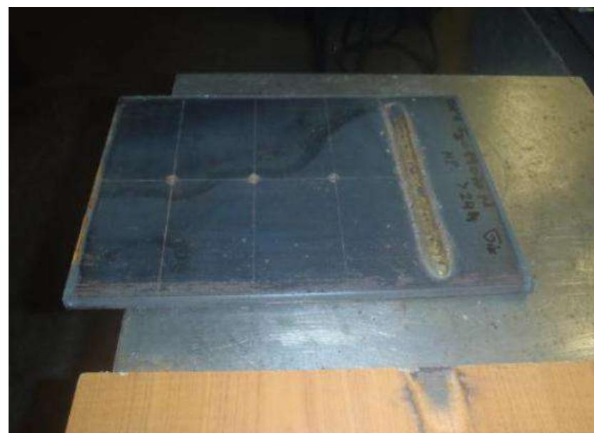
Slika 6.4 Prikaz navara na Implant ploči [17]
