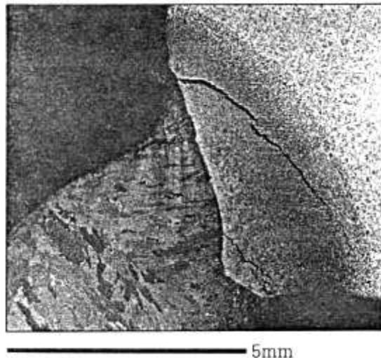
Slika 5.4 Primjer hladne pukotine u zavaru [15]
