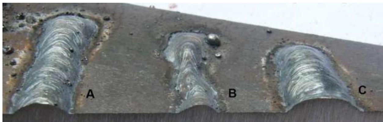
Slika 4.6 Uključci troske na površini zavarenog spoja
