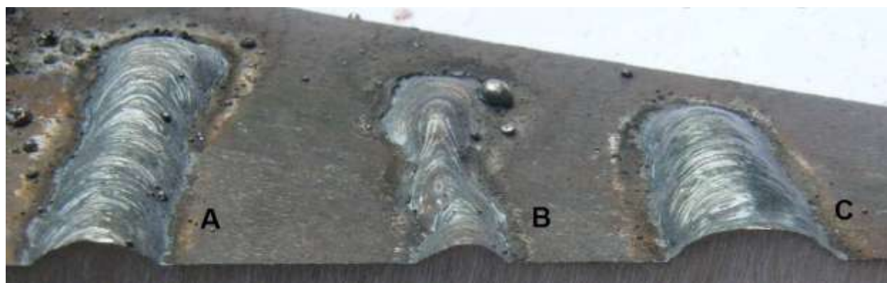
Slika 4.6 Uključci troske na površini zavarenog spoja
