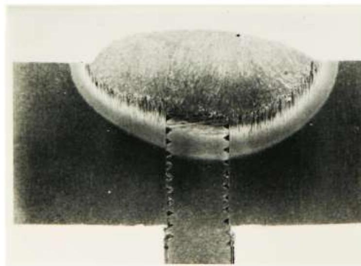
Slika 6.6 Implatni uzorak - spiralni utor [24]
