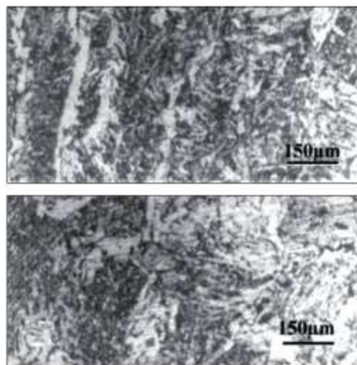
*Slika 6.17 Tipična mikrostruktura zavara kod CTS metode ispitivanja [30]*
