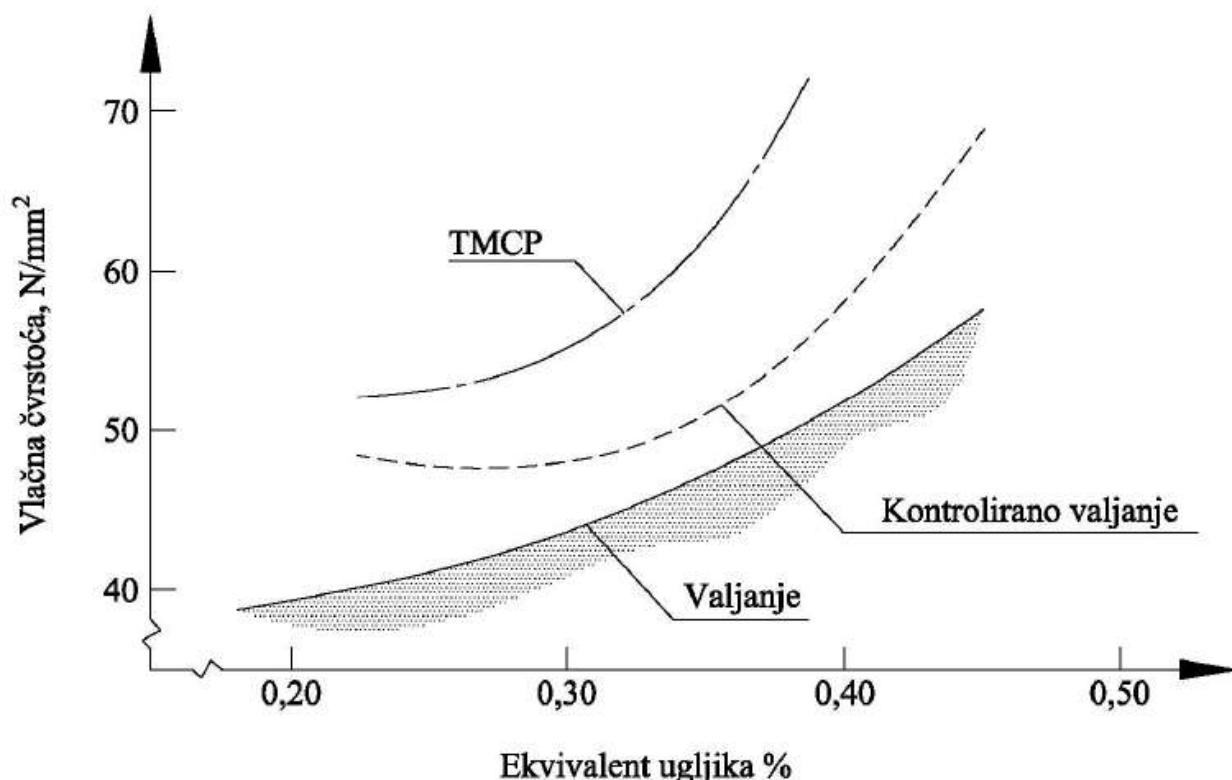
Slika 5.12 Odnos ekvivalenta ugljika ( $C_{ekv}$ ) i vlačne čvrstoće [16]
