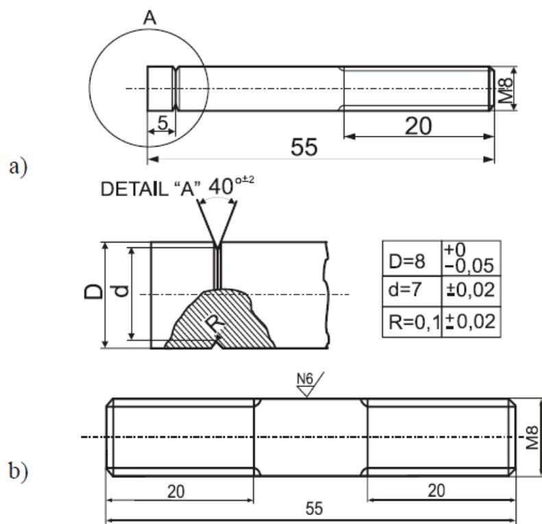
Slika 6.1 Dimenzije i oblik ispitne epruvete (implanta) za ispitivanje Implant probom
