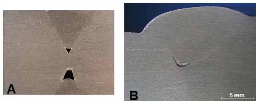
Slika 4.9 Primjeri pogrešaka naljepljivanja u zavarenom spoju
