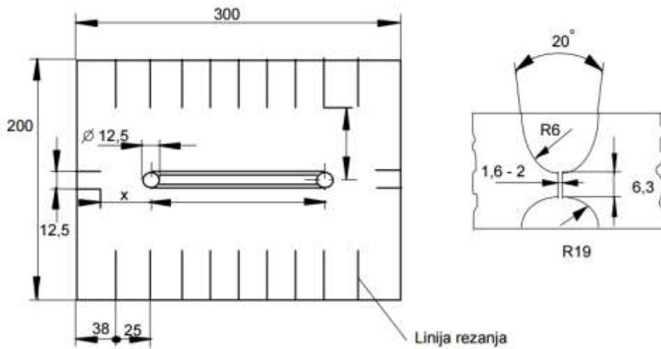
*Slika 6.19 Shema ispitivanja zavara pomoći Lehigh metode [28]*
