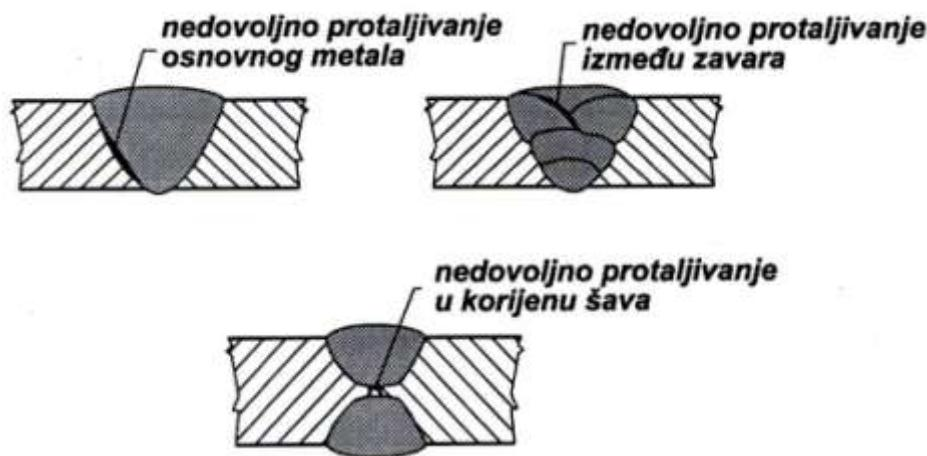
*Slika 4.7 Pogreške nedovoljnog provara, odnosno protaljivanja [9]*
