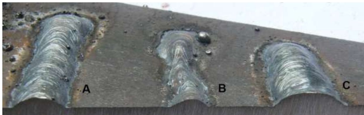
Slika 4.6 Uključci troske na površini zavarenog spoja
