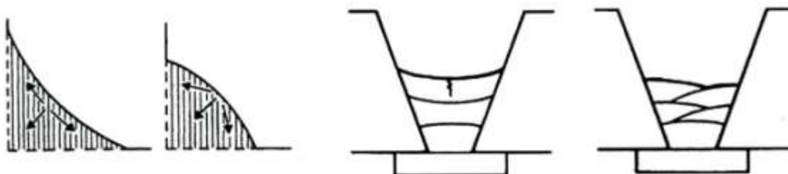
*Slika 5.18 Zavar udubljenog oblika (veća sklonost pojavi pukotina) i zavar blago ispuštenog oblika radi većih naprezanja na površini [5]*
