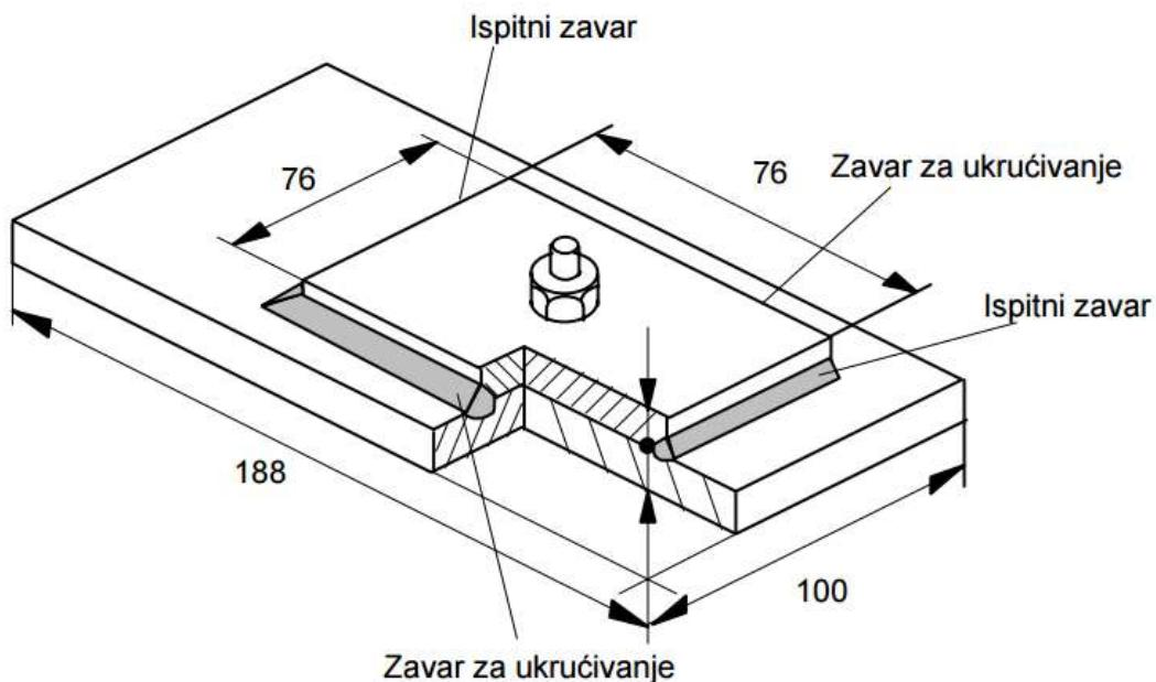
*Slika 6.14 Primjer ispitivanja zavarljivosti pomoći CTS metode [28]*
