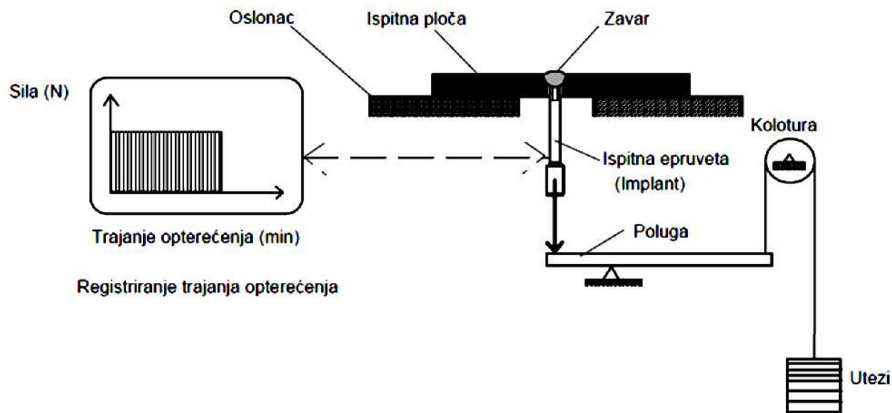
*Slika 6.3 Shematski prikaz uređaja za ispitivanje - Implant metoda [23]*
