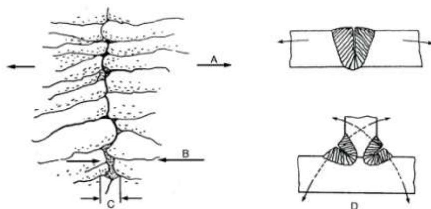
Slika 5.1 Shematski prikaz mehanizma nastajanja toplih pukotina
