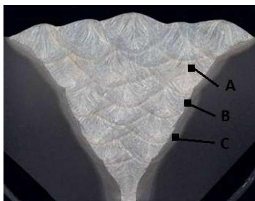
*Slika 2.1 Zavaren spoj, višeslojno zavarivanje, vezani slojevi
