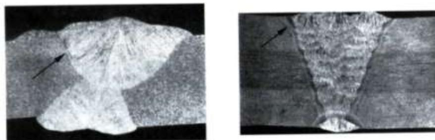
Slika 4.8 Manje pogreške naljepljivanja u zavarenom spoju [5]
