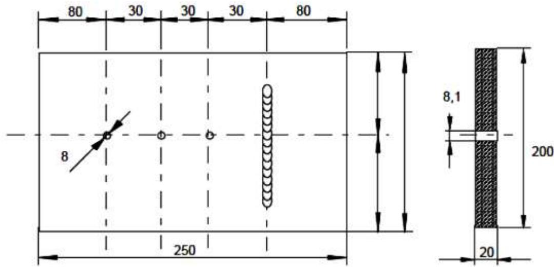
Slika 6.5 Izgled ispitne ploče po Implant metodi [23]
