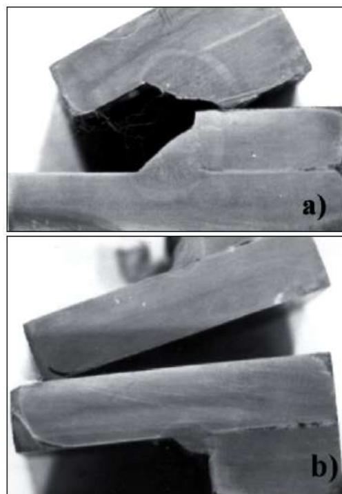
*Slika 6.16 Poprečni presjek ispitnog uzorka - CTS metoda
