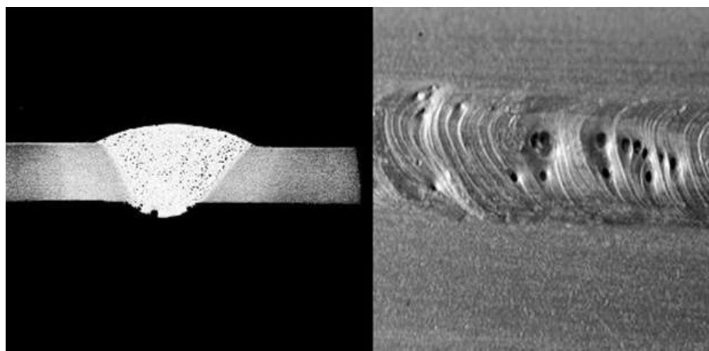
*Slika 4.3 Primjer poroznosti u zavarenim spoju (MIG zavarivanje) [10]*
