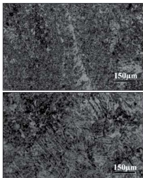
*Slika 6.18 CTS ispitivanje uzorka povišene kvalitete [30]*
