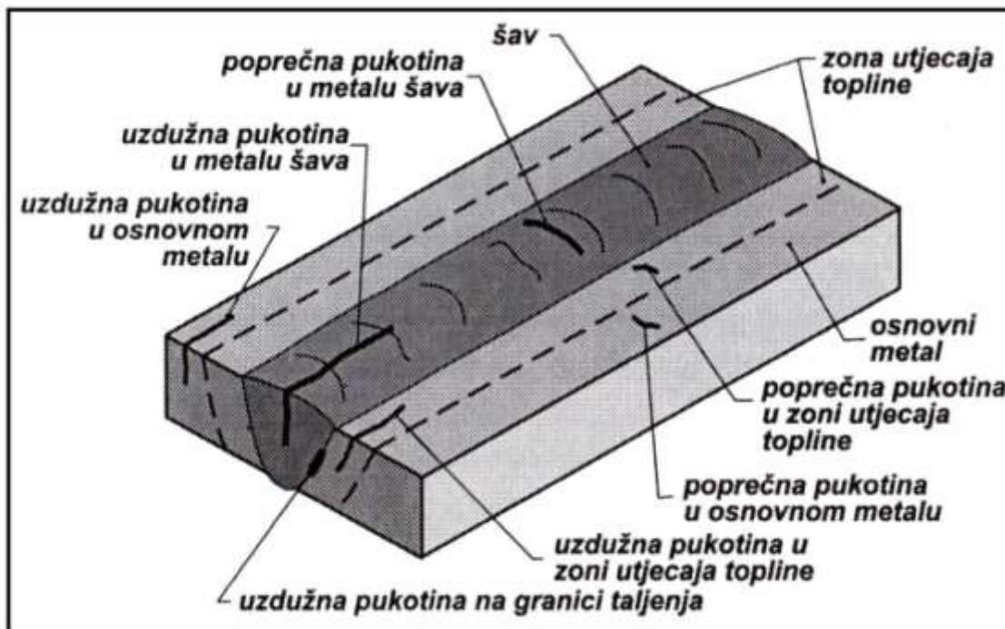
*Slika 4.1 Pukotine u zavarenom spaju [9]*
