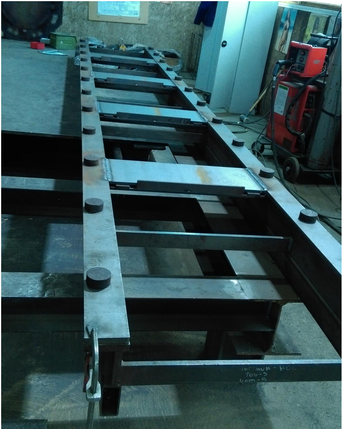
Slika 5.10 Pozicioniranje šina i poprečnih limova na horizontalnu napravu
