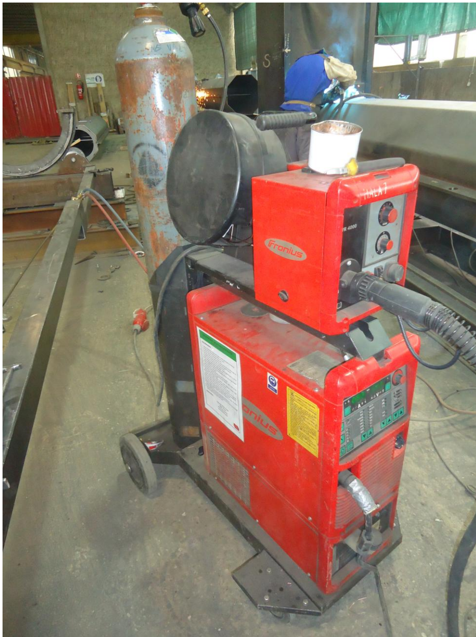
Slika 5.7 Aparat za zavarivanje Fronius TS 5000
