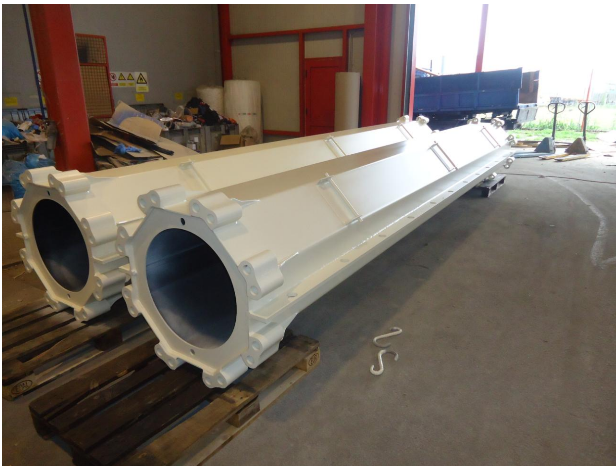
Slika 5.2 Cijevni jarbol nakon lakiranja
