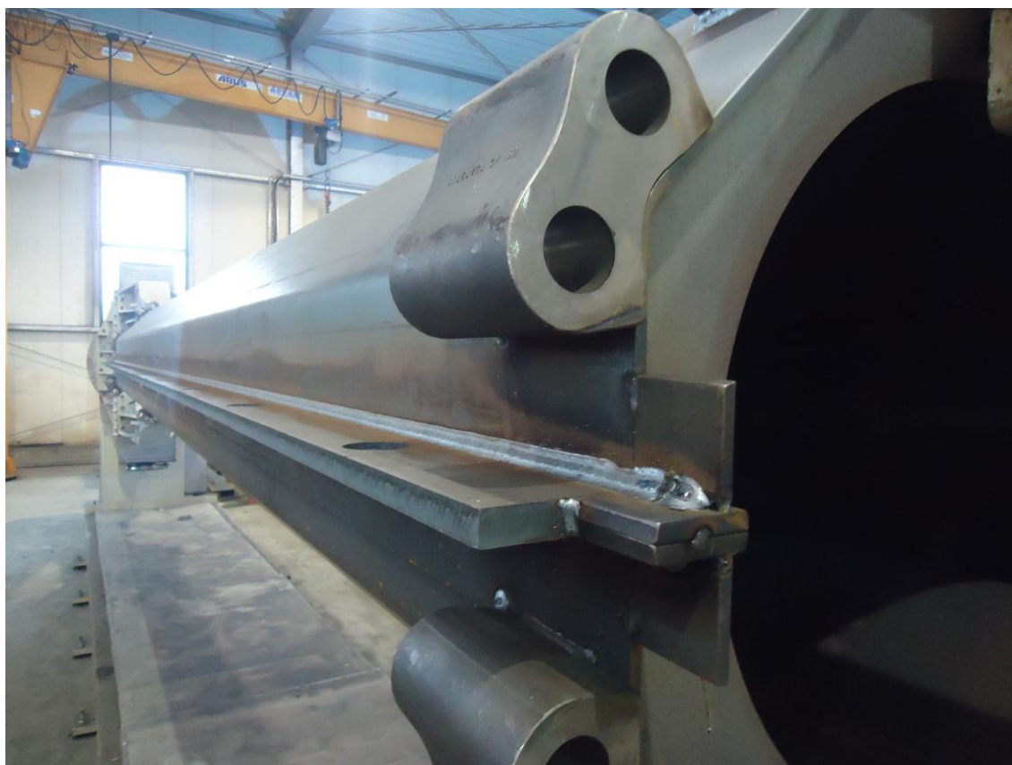
Slika 5.13 Izgled zavora između polovice cijevnog jarbola i šine
