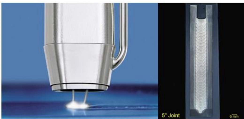
Slika 3.8 Prikaz Tandem MAG zavarivanja [14,15]
