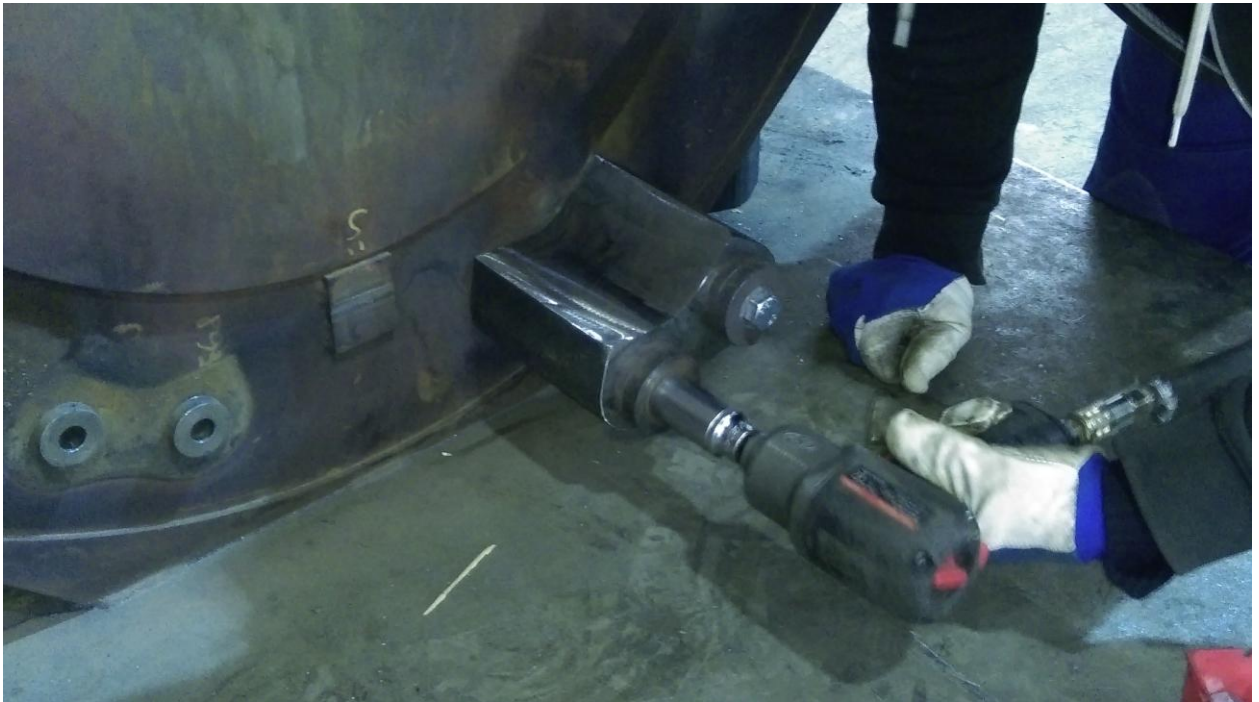
Slika 5.14 Pozicioniranje držača na vertikalnu napravu
