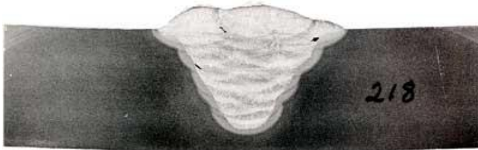
Slika 2.9 Uključak volframa u zavaru [8]
