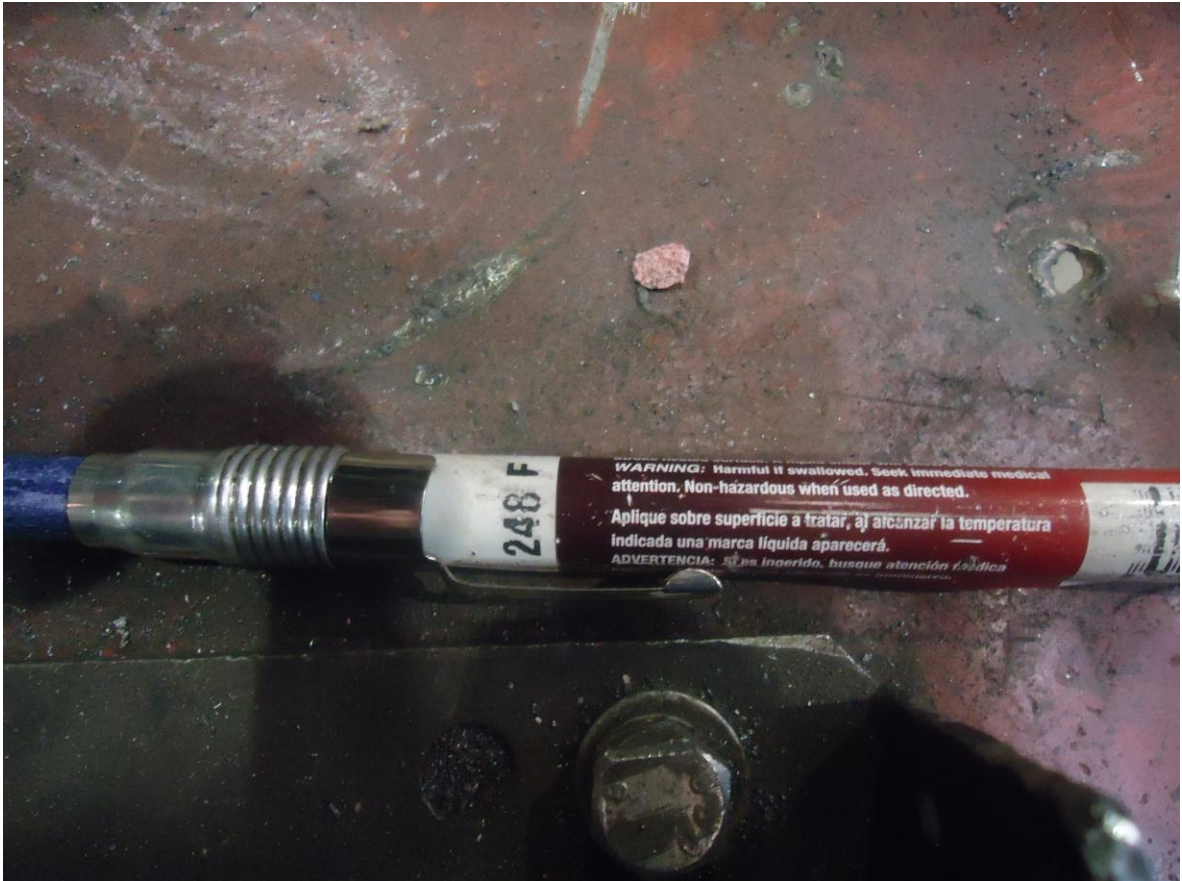
Slika 5.16 Kreda za predgrijavanje (120 °C)
