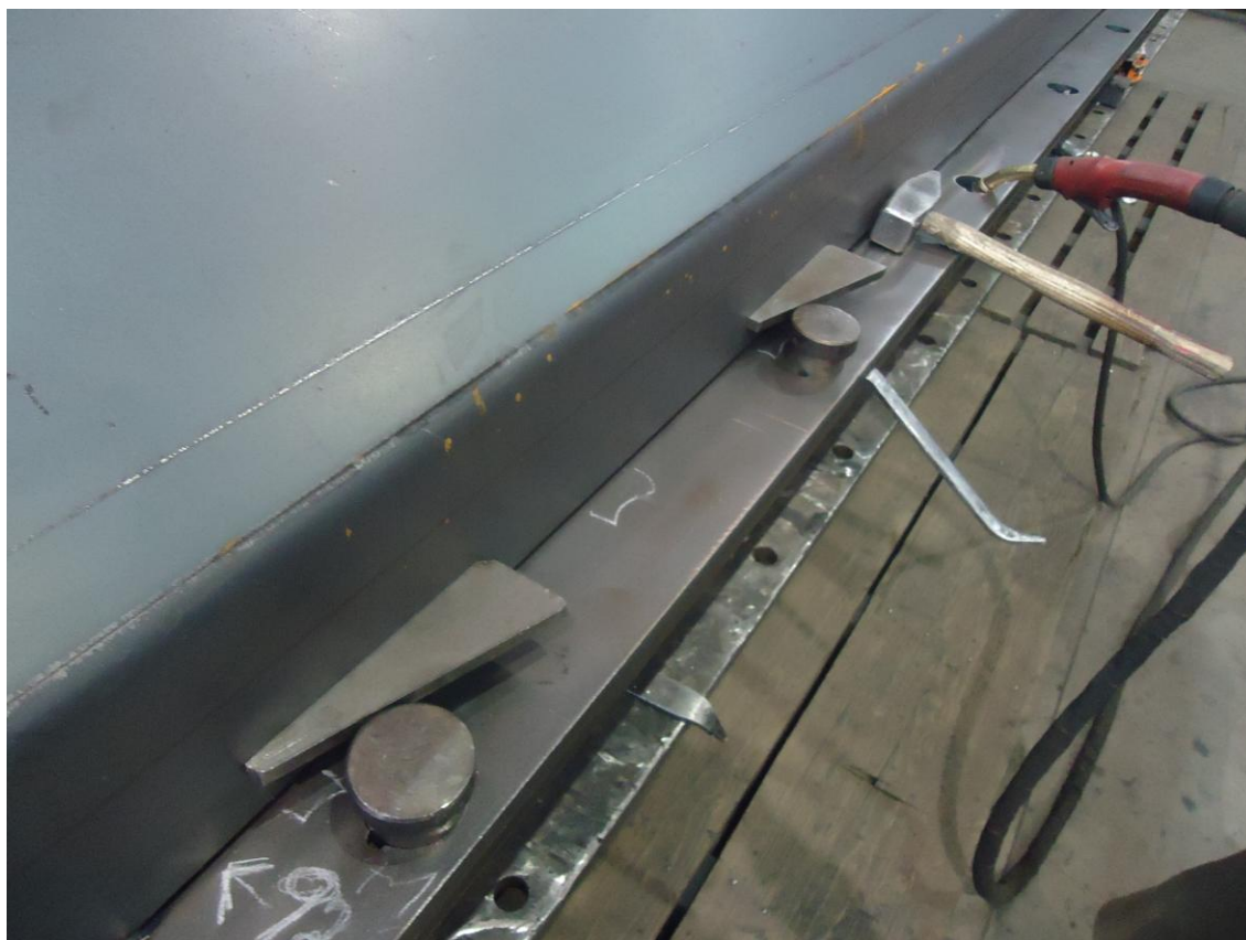
Slika 5.12 Pozicioniranje polovice cijevnog jarbola
