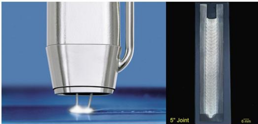
Slika 3.8 Prikaz Tandem MAG zavarivanja [14,15]
