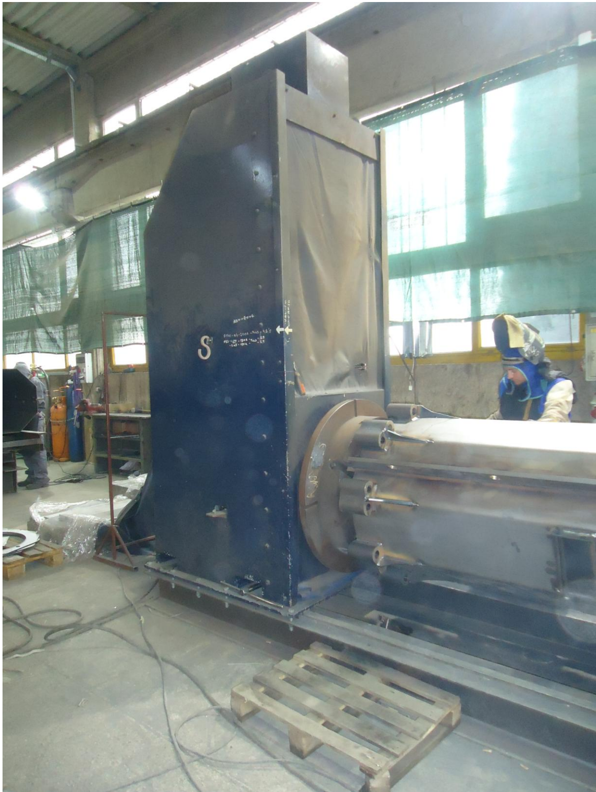
Slika 5.17 Zavarivanje držača na pozicioneru
