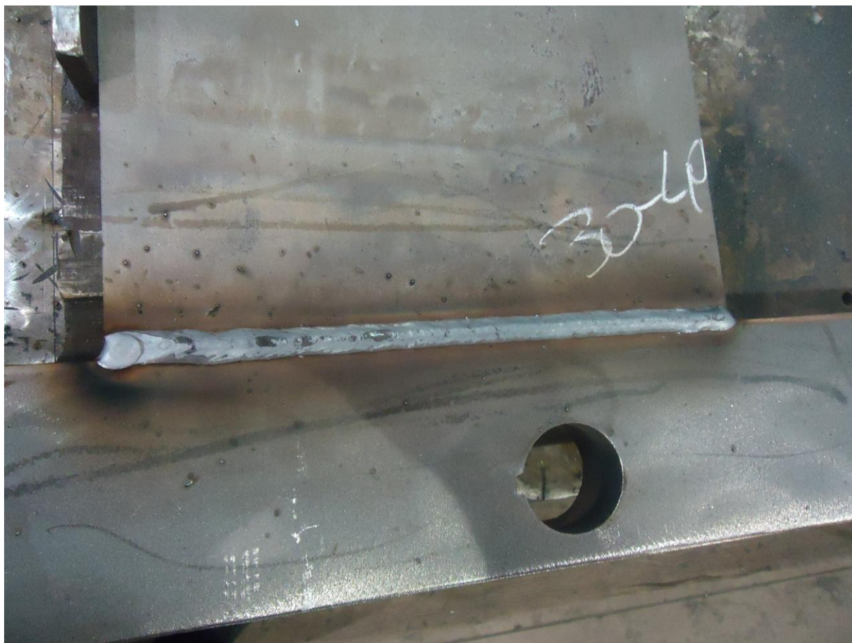
Slika 5.11 Izgled zavara (K-priprema)
