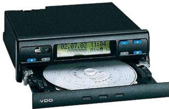
Slika 1 Prikaz analognog tahografa
