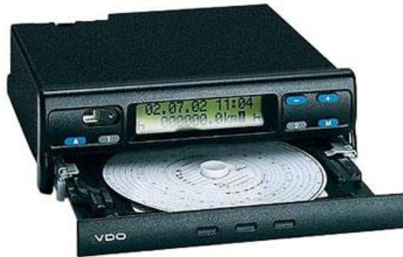
Slika 1 Prikaz analognog tahografa
