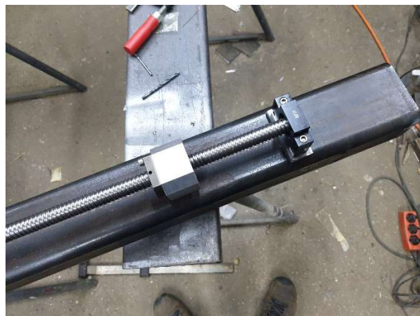
Slika 3.17 Namontirano kućište navojne matice
