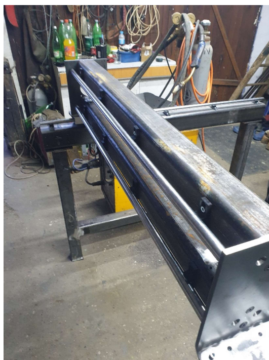
Slika 3.25 Montirane vodilice X osi
