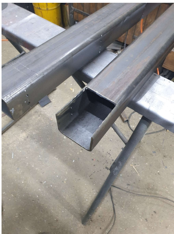
Slika 3.3 Prikaz utora za motor Y osi
