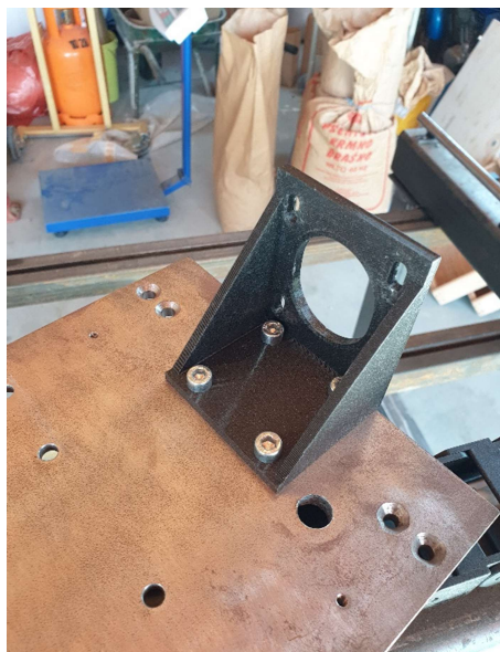
Slika 3.29 Montiranje nosača motora Z osi
