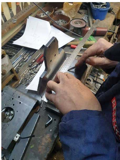
Slika 3.22 Obilježavanje pozicija za provrte
