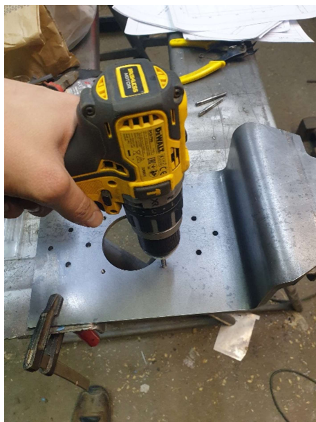
Slika 3.21 Urezivanje navoja za montiranje motora
