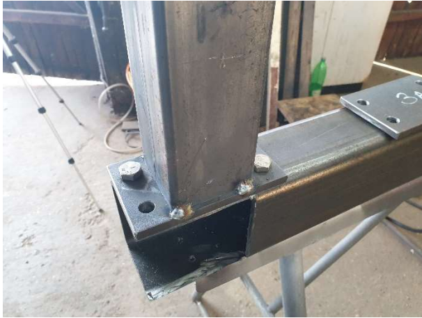
Slika 3.9 Noge i pločica CNC-a
