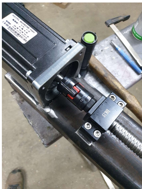
Slika 3.15 Montiranje blokova i navojne šipke
