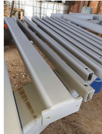
Slika 3.39 Premaz temeljnom bojom
