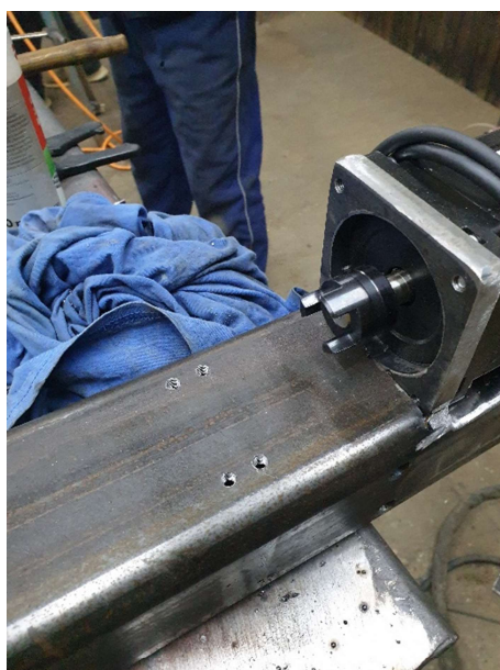
Slika 3.14 Provrt i navoj za montiranje BK15 i BF15 blokova
