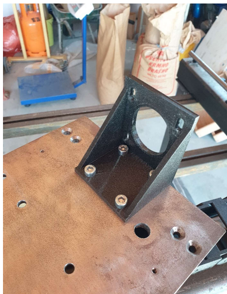
Slika 3.29 Montiranje nosača motora Z osi
