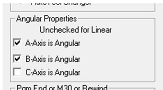
Slika 4.17 Postavljenje C osi u linearni način
