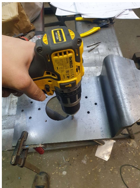
Slika 3.21 Urezivanje navoja za montiranje motora
