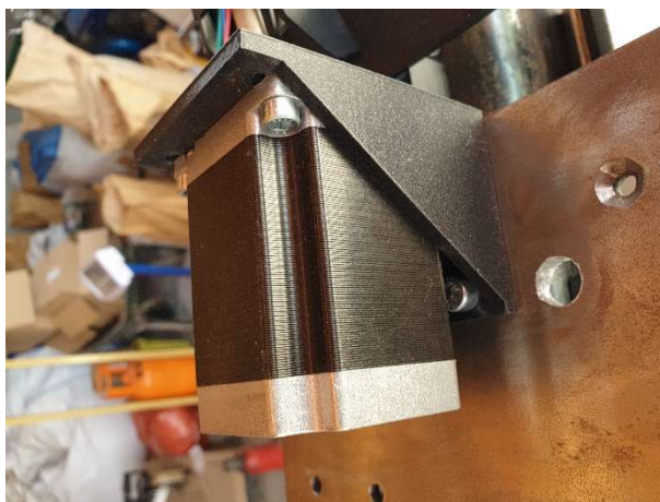
Slika 3.30 Montiranje motora Z osi
