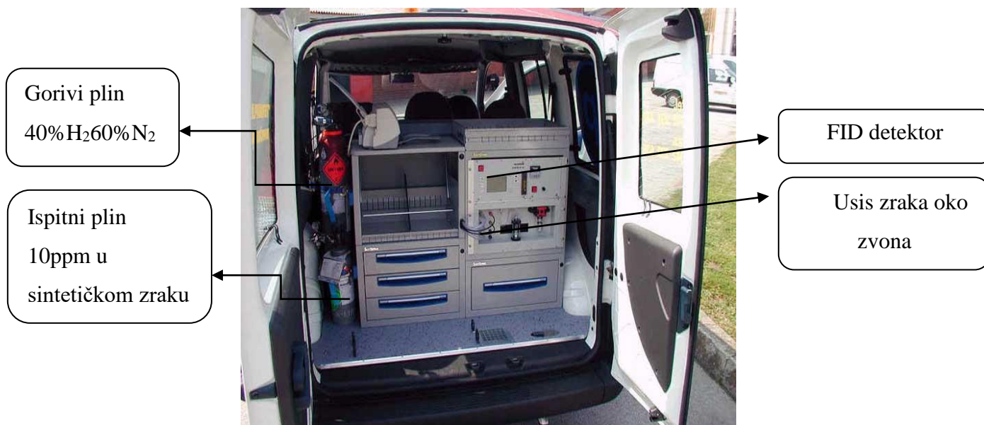
Slika 6.1 Unutrašnjost ispitnog vozila-oprema
