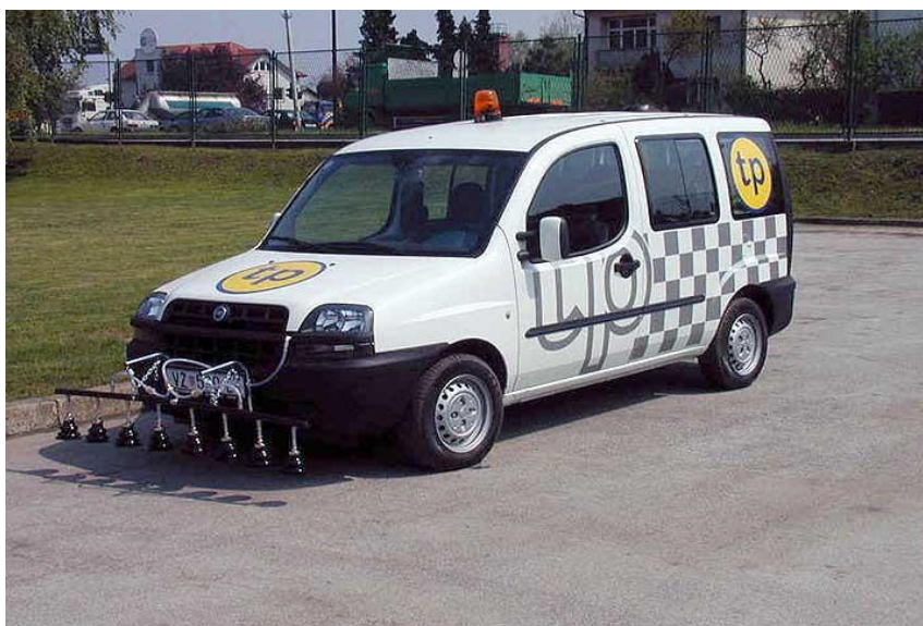
Slika 6.3 Ispitno vozilo PORTAFID.LP
