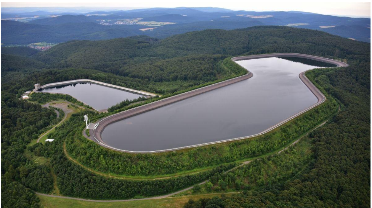
Slika 3.3 Gornji i donji rezervoar RHE Weldeck II
