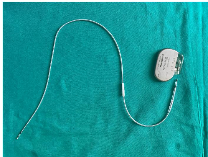
*Slika 3.1.: Jednokomorni elektrostimulator srca i elektroda*
