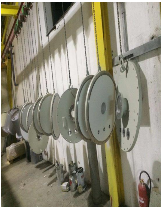
Slika 3.12 Poklopci nakon pjeskarenja
