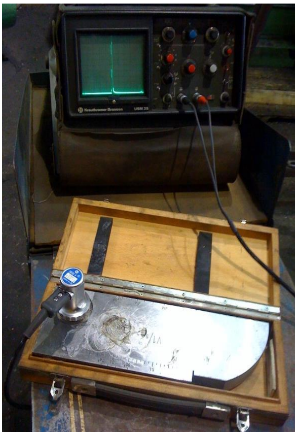
Slika 3.7 Baždarenje pomoću etalona
