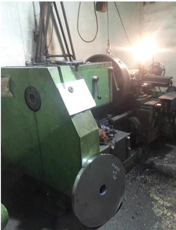
Slika 3.9 Strojna obrada poklopca
