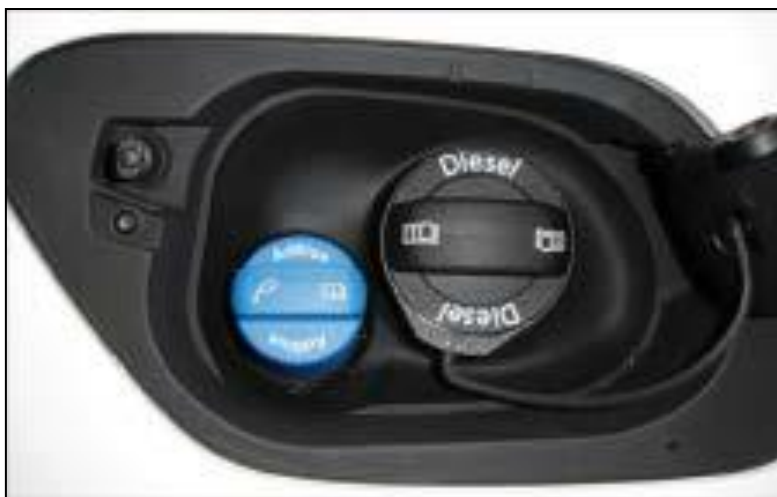
Slika 3.6.1.2. Otvor za točenje AdBlue tekućine [15]
