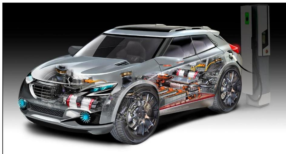
**Slika 6.2.** Priključno (plug-in) hibridno vozilo [4]
