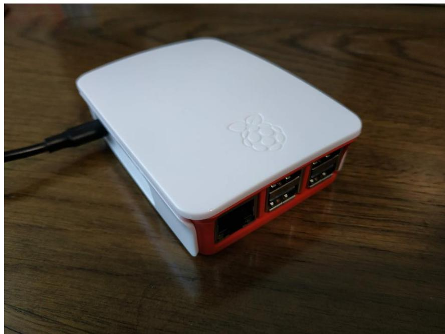
Slika 20 Raspberry Pi 3B u kućištu
