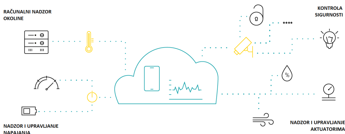
Slika 4 Prikaz prvog sloja IoT arhitekture [7]
