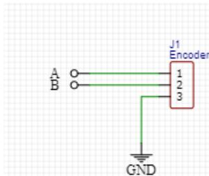
Slika 17. Shema sklopa spajanja enkodera
