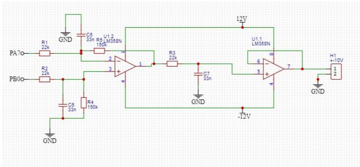
Slika 18. Shema sklopa za dobivanje analognog izlaznog signala
