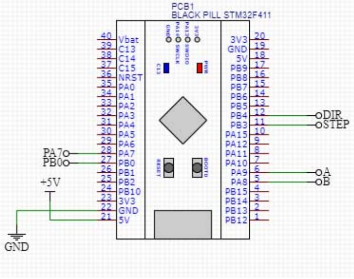
Slika 14. Shema spajanja signala na mikrokontrolersku pločicu
