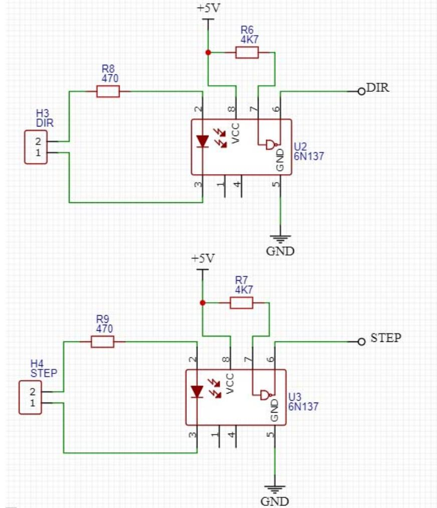
Slika 16. Shema sklopa za galvansko odvajanje signala
