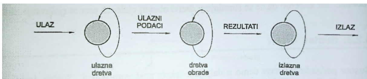
Slika 31: Cikličke dretve u ostvarenju cjevovodne obrade
