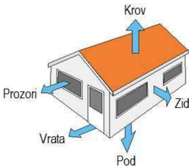
Slika 4.2 Ilustracija prijelaza topline iz prostorije
