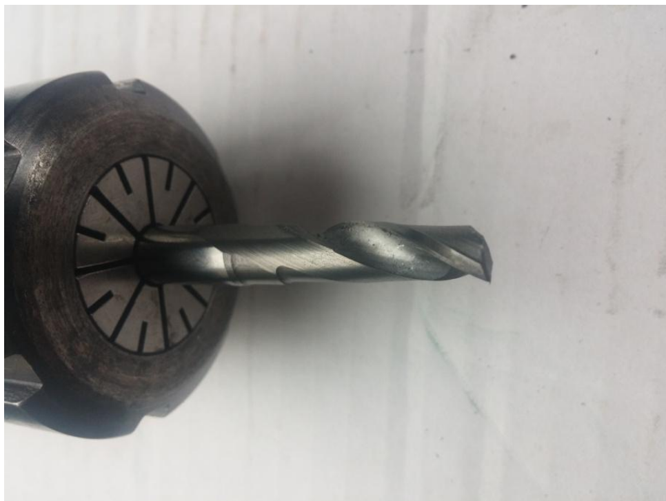
Slika 4.4.3 Glodalo D8 za grubu obradu [2]
