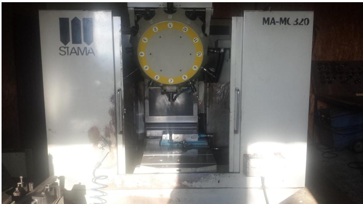
Slika 4.1.1 CNC obradni centar Stama MC-320 [2]
