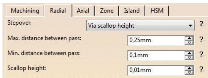
Slika 5.2.19 Preklapanje kod fine poprečne obrade [3]
