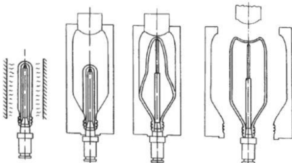
**Slika 2.2** Postupak injekcijskog puhanja [1]
