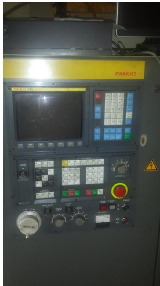
Slika 4.3.1 Fanuc 0-M upravljačka jedinica [2]
