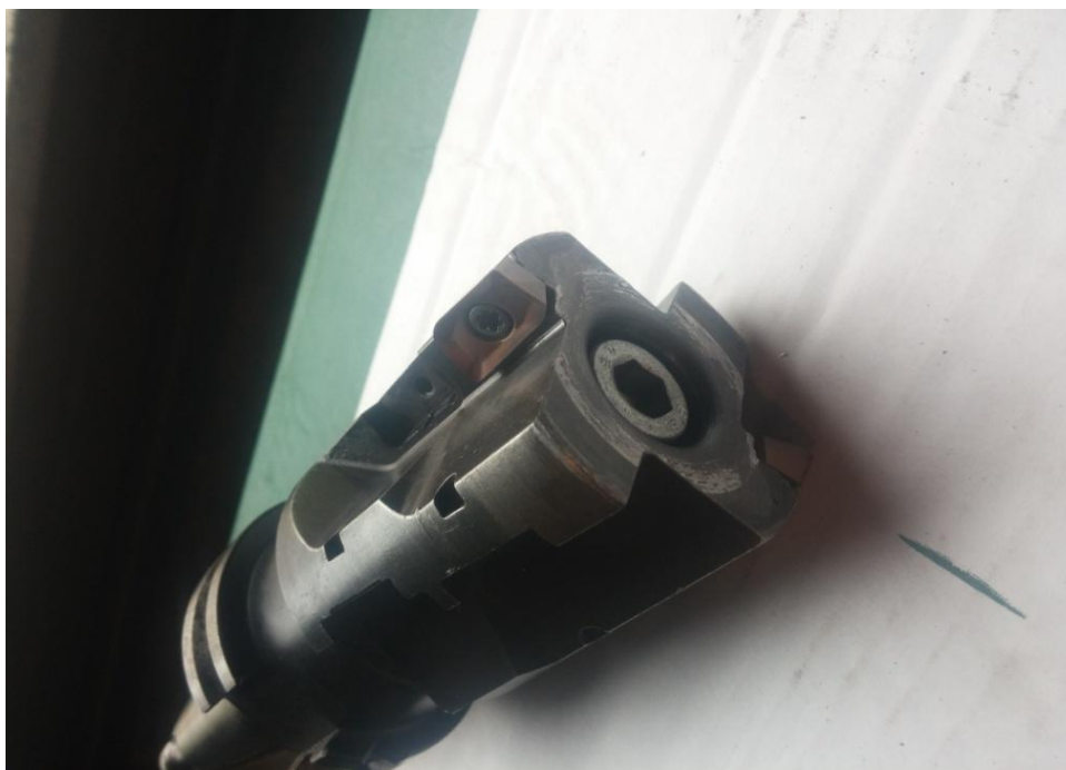
Slika 4.4.2 Glodalo D50 za poravnavanje [2]
