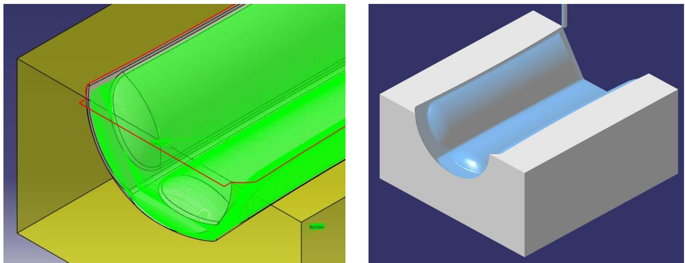
Slika 5.2.21 Simulacija finog poprečnog glodanja [3]
