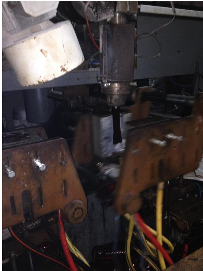
Slika 4.5.2 Izlazak smjese iz ekstrudera [5]
