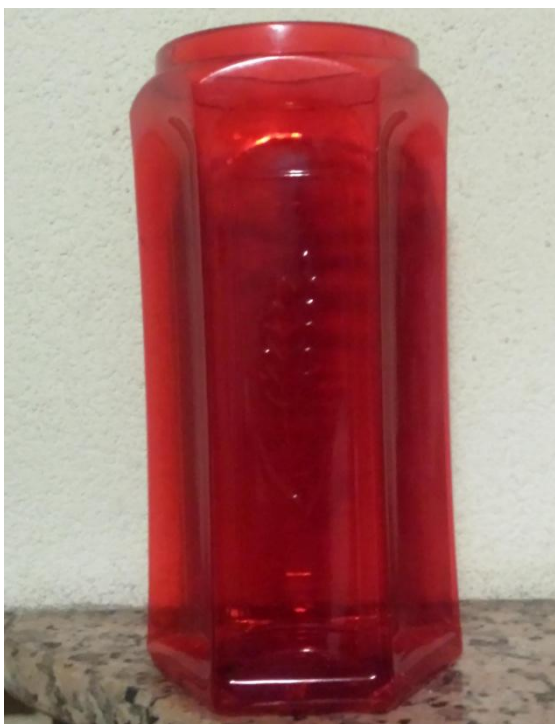
Slika 4.5.4 Plastika nakon puhanja [5]
