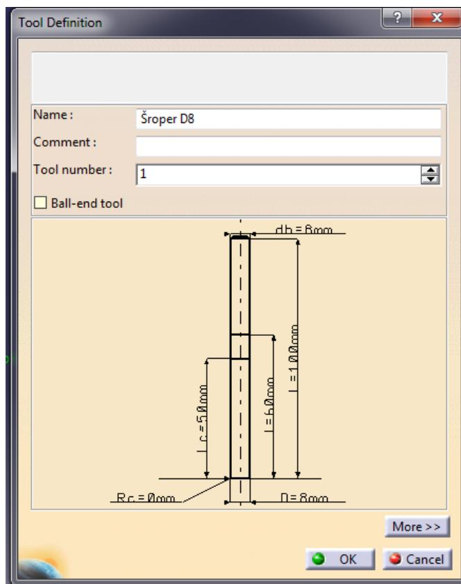
**Slika 5.2.5** Izgled alata za grubo glodanje [3]
