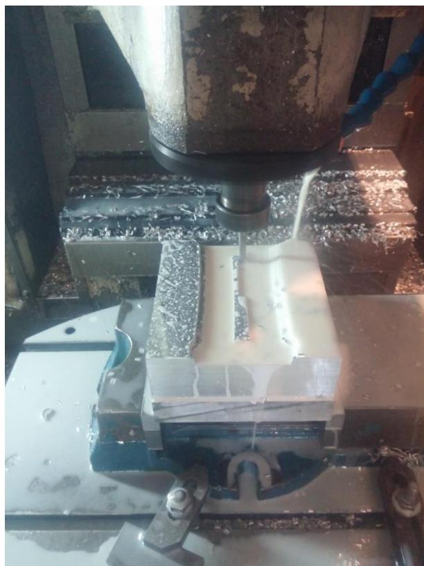
**Slika 5.2.11** Grubo glodanje na stroju [2]
