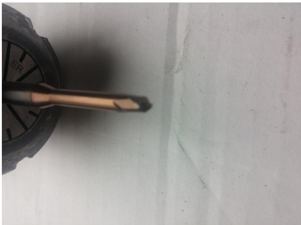
**Slika 4.4.4** Glodal za finu obradu D4 [2]
