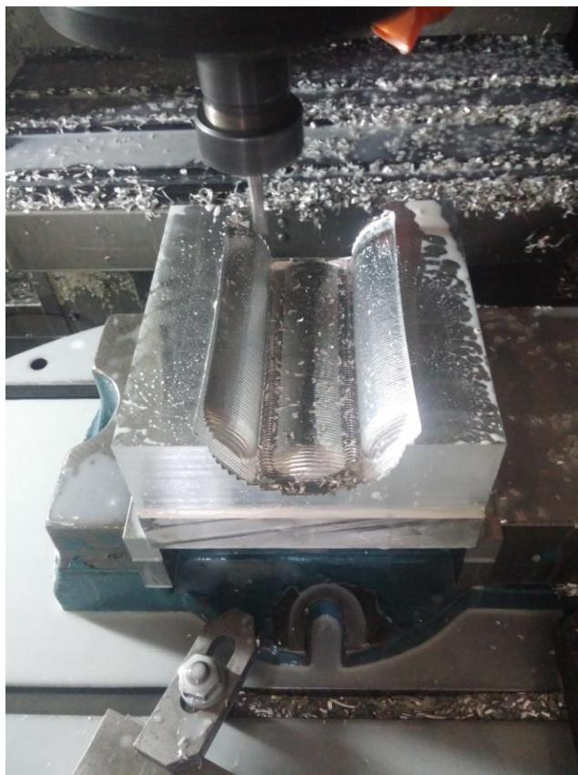
Slika 5.2.17 Grubo poprečno glodanje na stroju [2]
