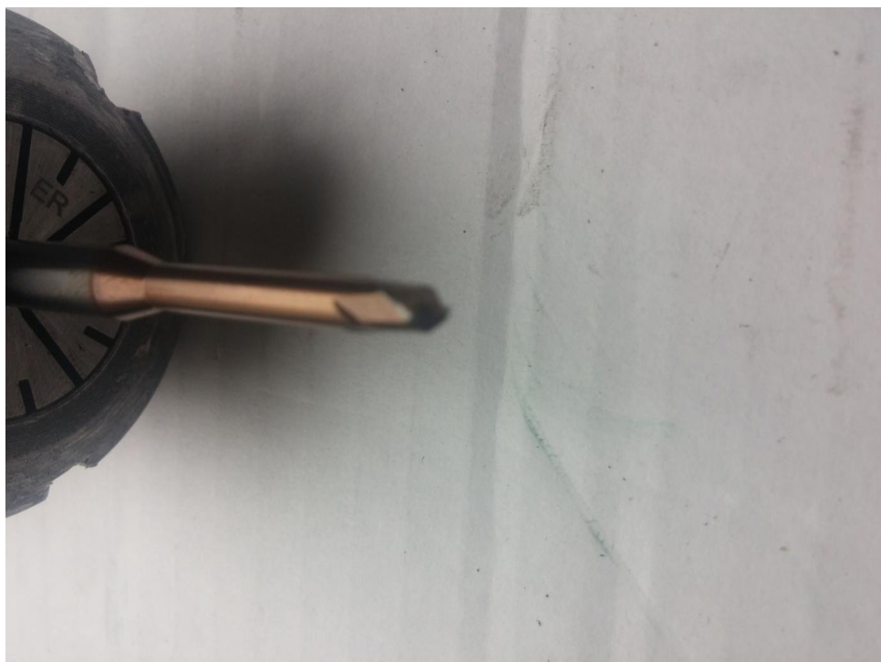
Slika 4.4.4 Glodalo za finu obradu D4 [2]
