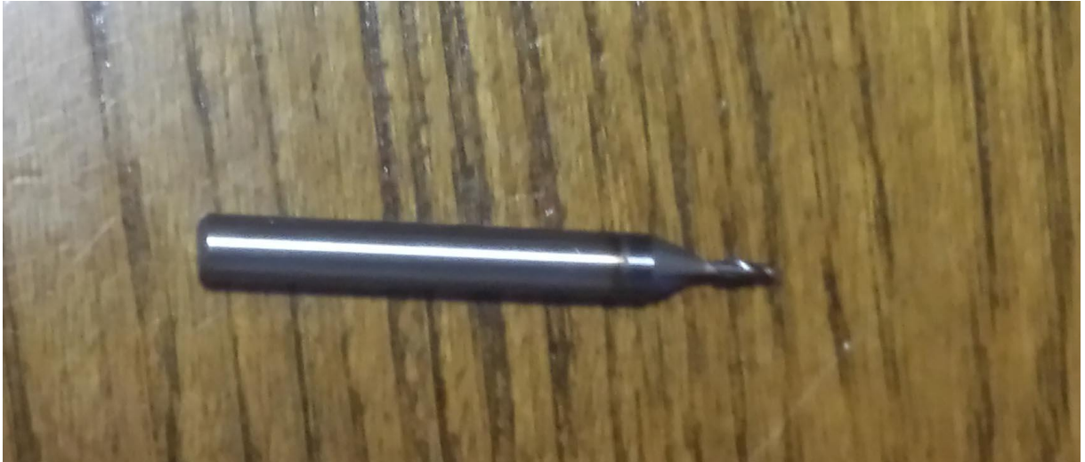
Slika 4.4.5 Glodalo za kanal D2 [2]
