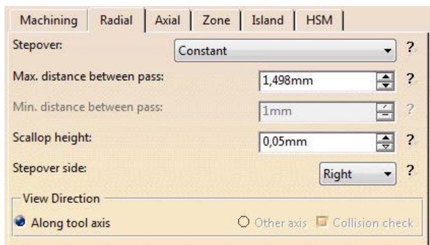
**Slika 5.2.13** Preklapanje kod grube poprečne obrade [3]
