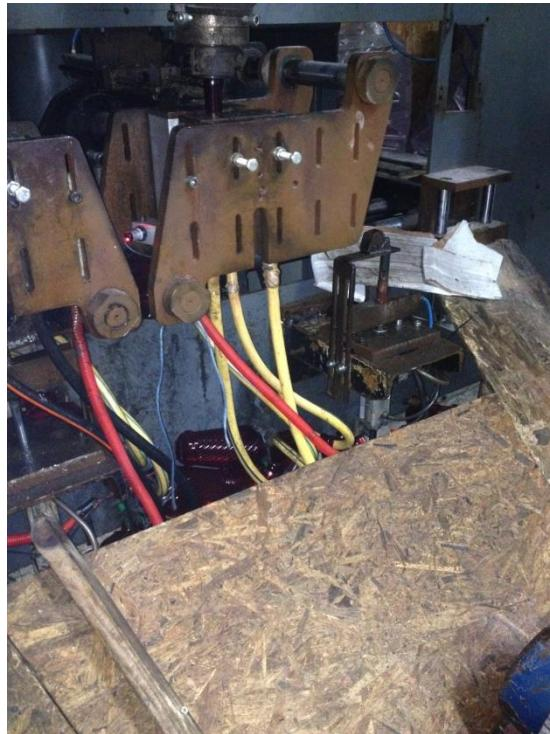
**Slika 4.5.3** Zatvaranje alata pomoću hidraulike [5]
