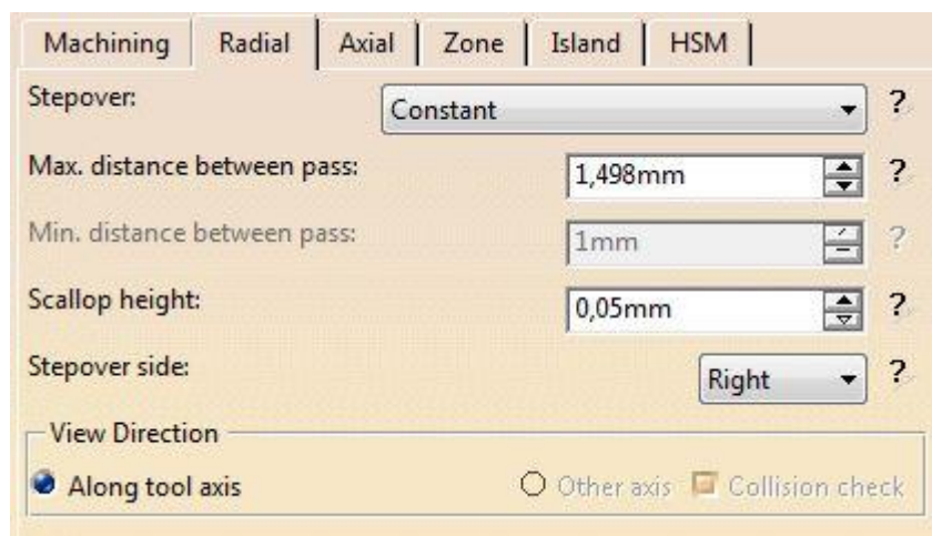
Slika 5.2.13 Preklapanje kod grube poprečne obrade [3]
