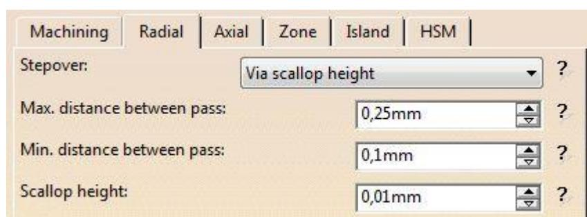
Slika 5.2.19 Preklapanje kod fine poprečne obrade [3]
