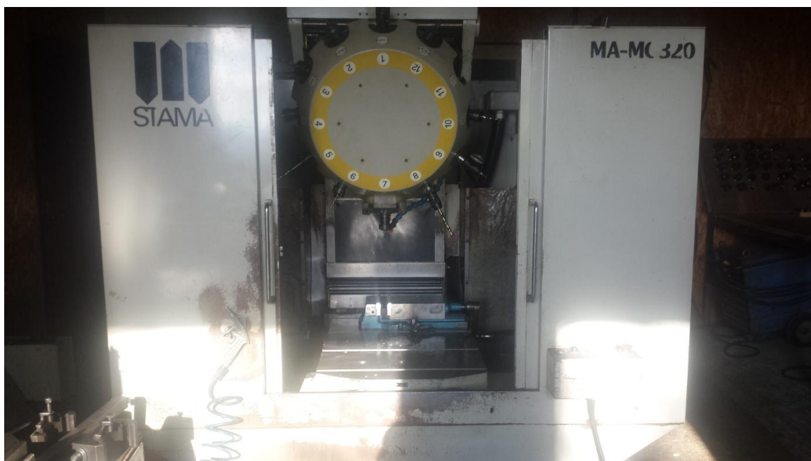
Slika 4.1.1 CNC obradni centar Stama MC-320 [2]
