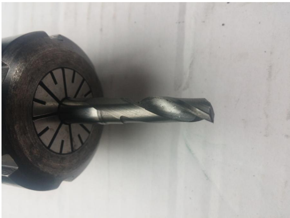
Slika 4.4.3 Glodalo D8 za grubu obradu [2]
