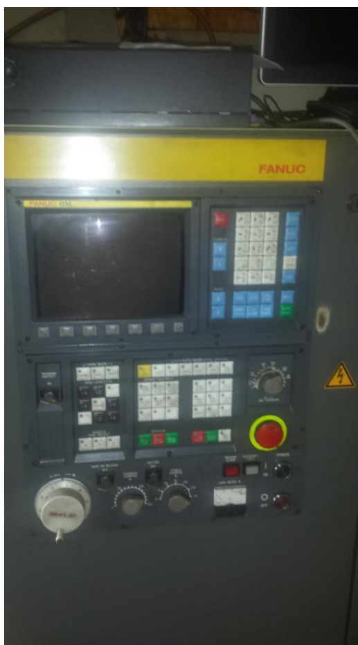
Slika 4.3.1 Fanuc 0-M upravljačka jedinica [2]
