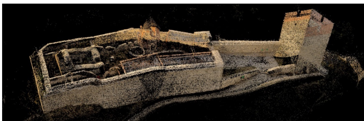
Slika 5.33 Točkasti oblak proizveden kružnim planom leta
