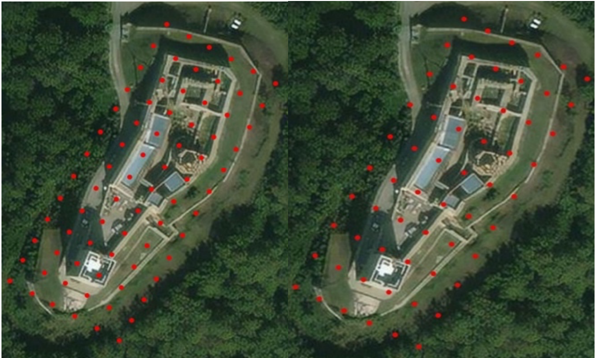
Slika 5.27 Prikaz pozicija slikanja za 85% (lijevo) i 80% (desno) preklapanje
