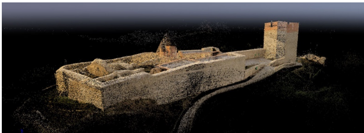
Slika 5.26 Točkasti oblak od 90% preklapanja
