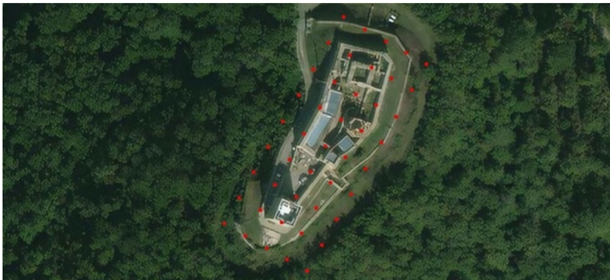
Slika 5.30 Prikaz pozicija slikanja za 75% preklapanje
