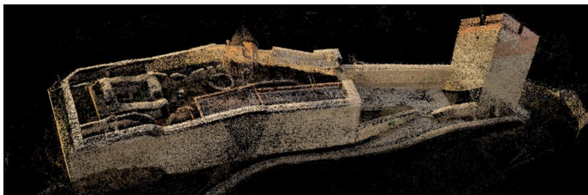
Slika 5.33 Točkasti oblak proizveden kružnim planom leta
