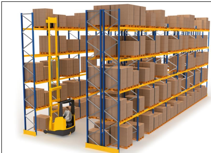
Slika 19. Prikaz visokoregalnog paletnog skladišta jednostruke dubine
