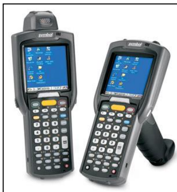
Slika 22. RF scanner, ručni čitač za zaprimanje robe
