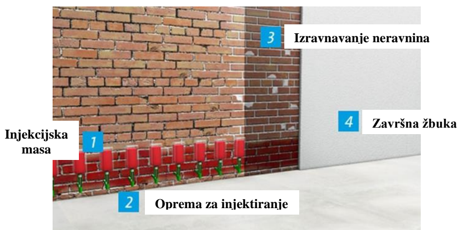
Slika 5.24 Injektiranje bez tlaka
